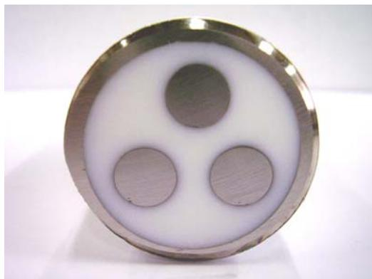
Figura III.1: Exemplo de um corpo-de-prova utilizado nos ensaios eletroquímicos.
