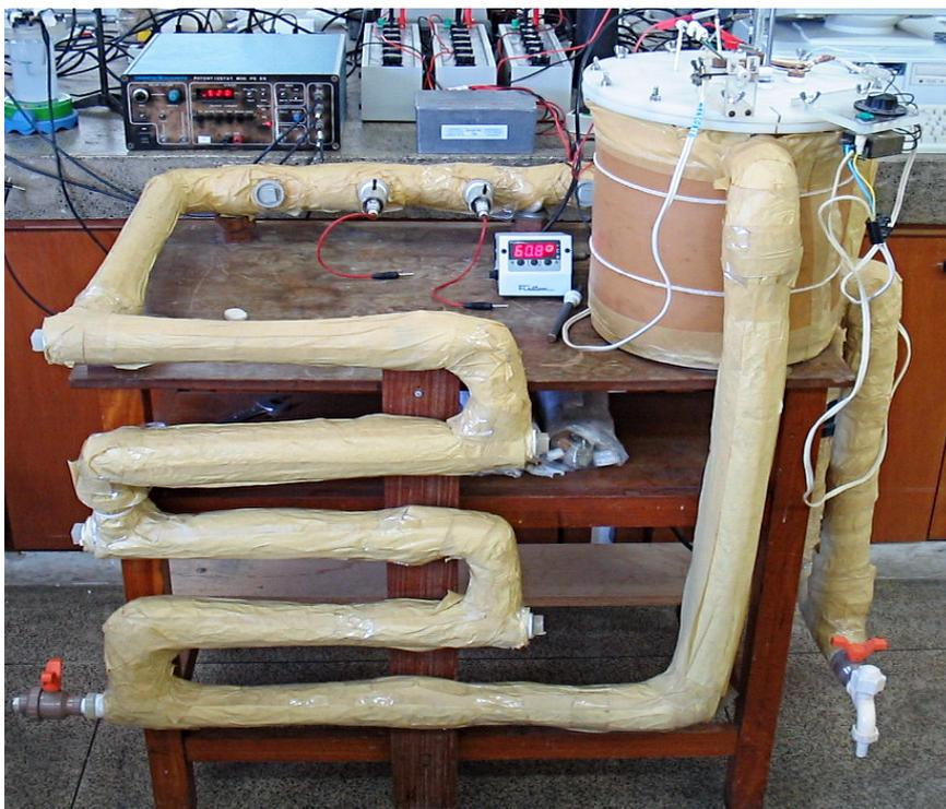
Figura III.3: Sistema de circuito fechado (Loop) utilizado nos ensaios.
