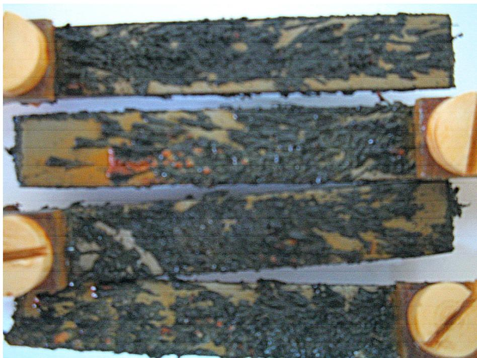
Figura IV.20 – Cupom de perda de massa em meio isento de inibidor a 60°C e pH 7,5 (72 horas de imersão).
