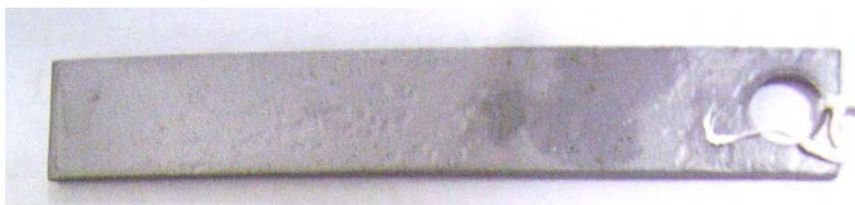
Figura III.2: Exemplo de um cupom de perda massa utilizado no Loop.
