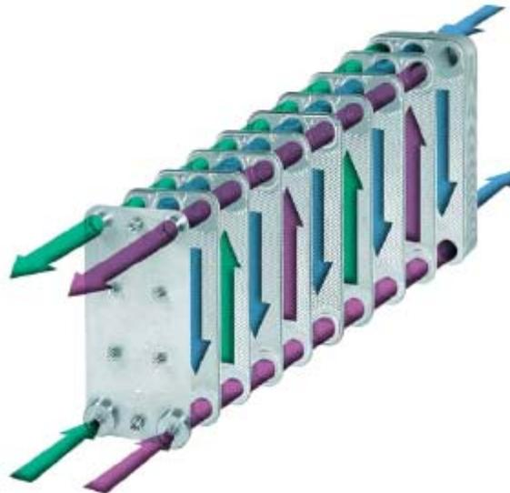
Figura II.4: Esquema de um trocador de calor de placas. [13]
