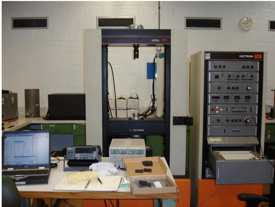
Figura 22 - Vista geral do local dos ensaios de medição da RCI, com destaque para a máquina Instron Modelo 1125 (Laboratório de Propriedades Mecânicas MA-4 da DVLF - CEPEL).
