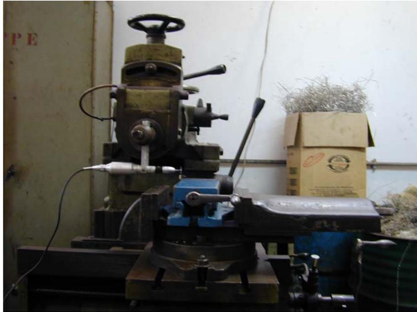
Figura 9- Foto da plaina com o micro motor adaptado para fazer o afinamento do pré-entalhe.
