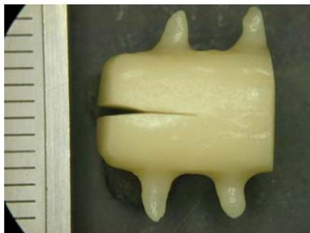
Figura 10- Corpo de prova de cerâmica pura com o entalhe pronto.
