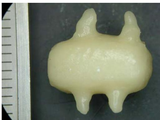
Figura 7- Foto do corpo de prova de cerâmica pura antes da abertura da trinca.
