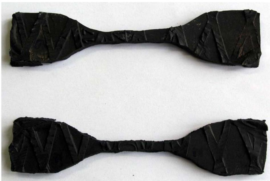
Figura 18. Corpos de prova para o ensaio de tração.
