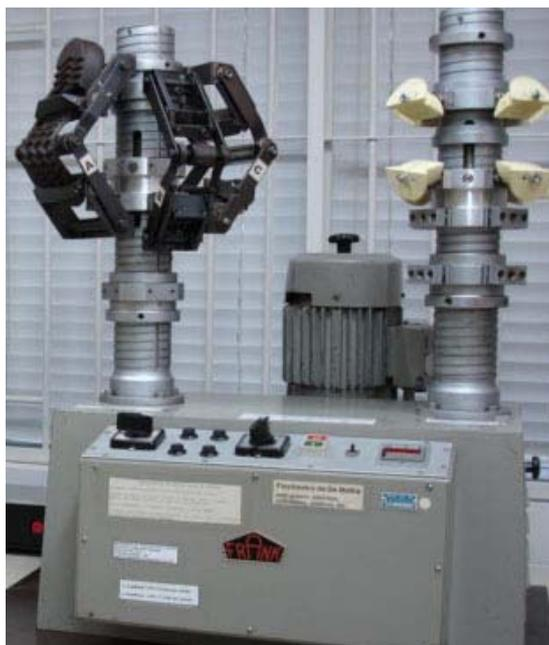
Figura 17. Máquina para a realização do ensaio de flexionamento contínuo em solas.
