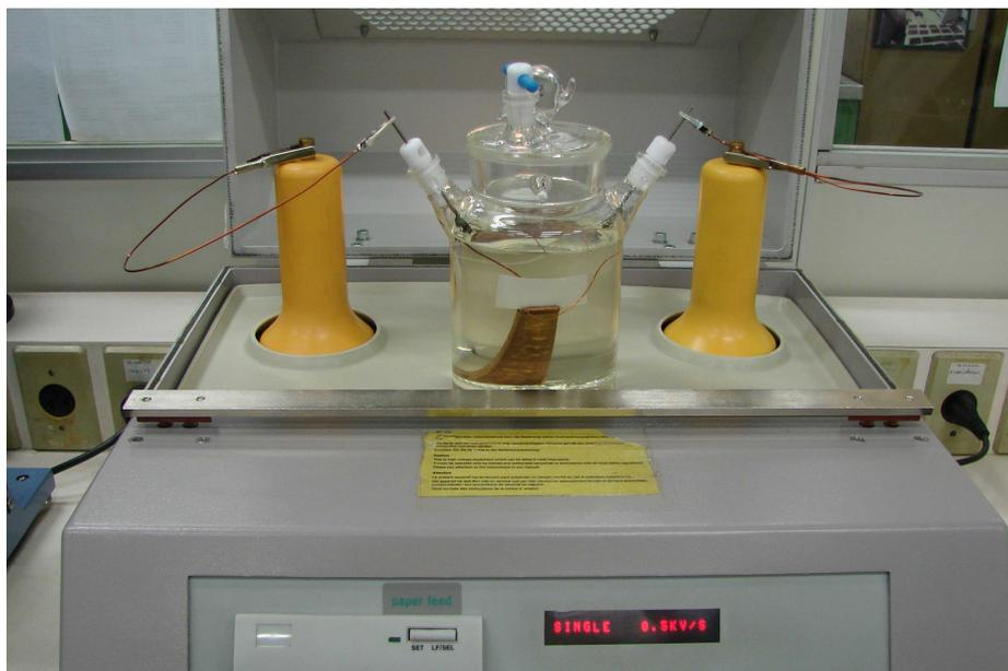
Figura 13 – Configuração para determinação da rigidez dielétrica da amostra capacitiva imersa em óleo.
