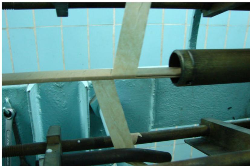
Figura 22 – Detalhe do empapelamento duplo do condutor.
