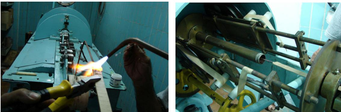
Figura 21 - Soldagem de uma guia ao condutor para ser guiado pela máquina empapeladora.
