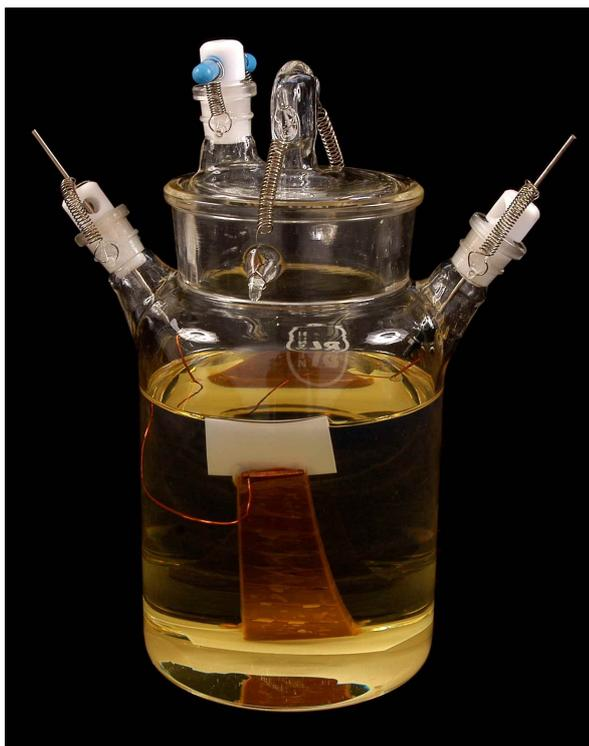
Figura 18 - Detalhe da célula de ensaio contendo amostra capacitiva e óleo.
