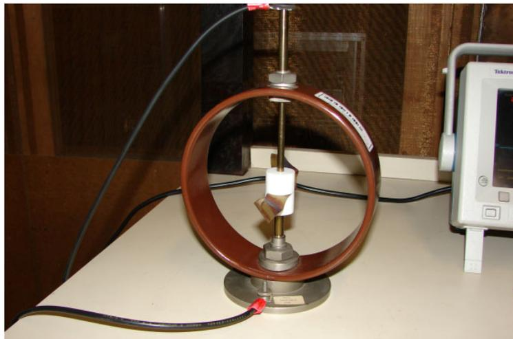
Figura 11 – Configuração para determinação da rigidez dielétrica do papel utilizando eletrodos de latão encapsulados em teflon.
