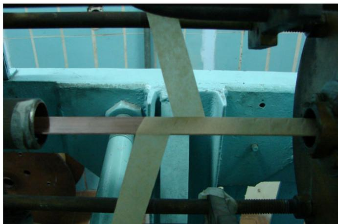
Figura 19 – Detalhe do empapelamento do condutor. Observa-se a sobreposição de 50 % do papel e o ângulo de sobreposição de 75°.
