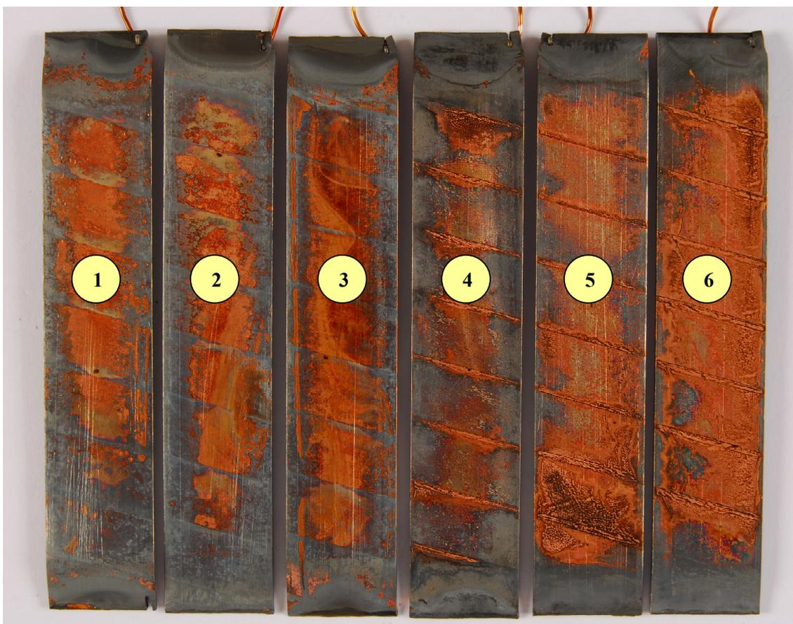
Figura 28 – Face interna das placas de cobre das amostras capacitivas após 32 dias de envelhecimento.
