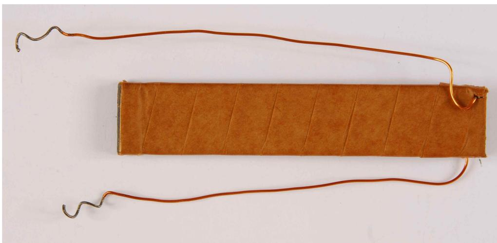
Figura 23 – Amostra capacitiva medindo 100 mm de comprimento. Vista de frente com fios condutores conectados. Amostra após 32 dias de ensaio.
