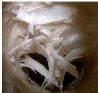
**Figura 48 – Modo de falha do tipo U no tubo compósito 2c4h2c\_55S: falhas no interior.**
