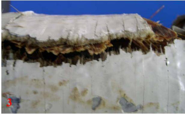
**Figura 51 – Detalhes das fraturas do tubo 4c8h2c\_55S. Nas figuras centrais (1 e 2) pose-se ver o rompimento das fibras circunferenciais; na última figura (3) observa-se o rompimento das camadas circunferenciais e helicoidais conjuntamente.**
