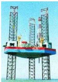
**Figura 1 - Plataforma Auto-elevatória (*Jack-up*).**
