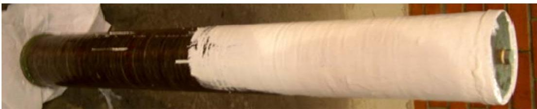
**Figura 44 - Aplicação de tinta epóxi na superfície do tubo.**
