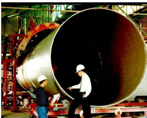
**Figura 23 - Fabricação de tubo compósito pelo processo Drostholm.**
