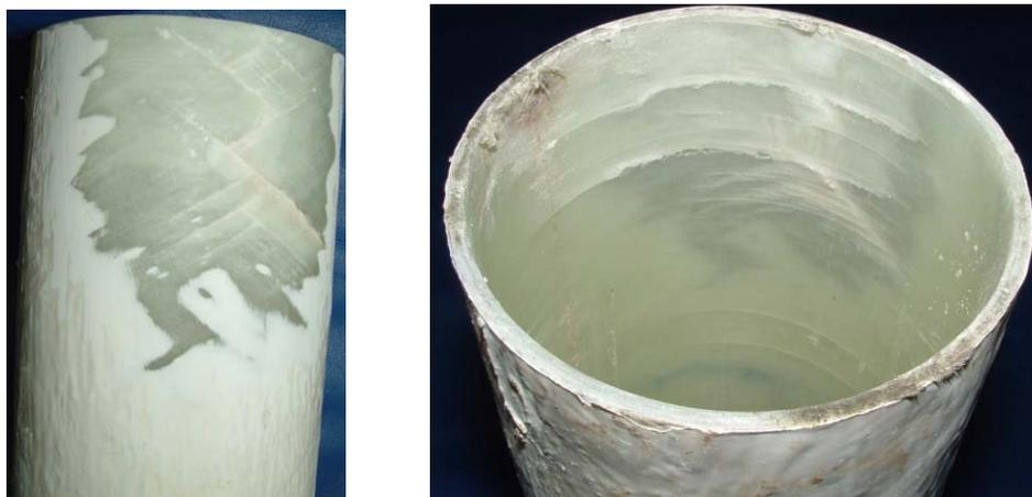
**Figura 55 – Detalhes das fraturas observadas no tubo 8c8h\_55E: trincas externas (esquerda) e trincas internas (direita).**
