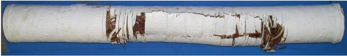
**Figura 50 – Tubo 4c8h2c\_55S após ensaio hidrostático.**
