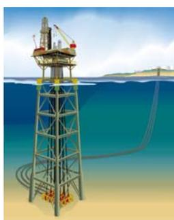
**Figura 2 - Plataforma em Jaqueta (*Steel Jacket*).**
