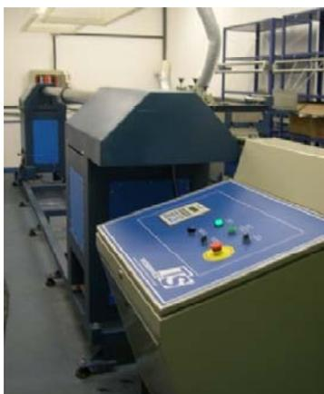
**Figura 33 – Máquina de enrolamento filamental.**
