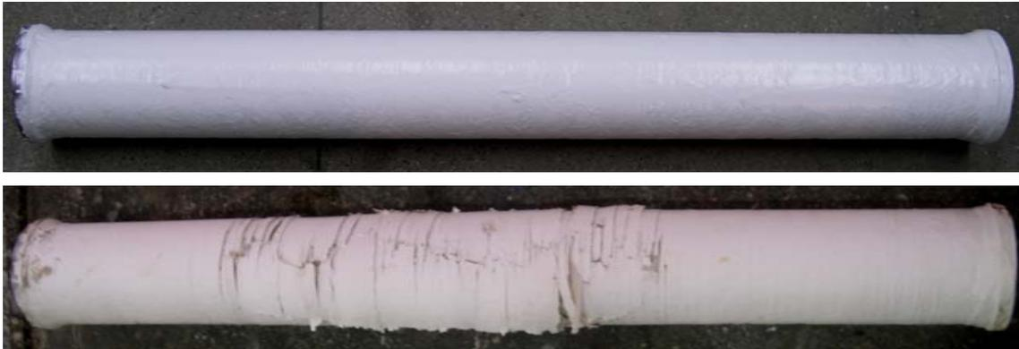
**Figura 46 – Tubo 2c4h2c\_55S antes (superior) e depois (inferior) do ensaio hidrostático.**
