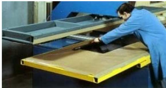
Figura 22 - Fabricação de tubo por meio de uma mesa de rolamento (*Table Rolling*).
