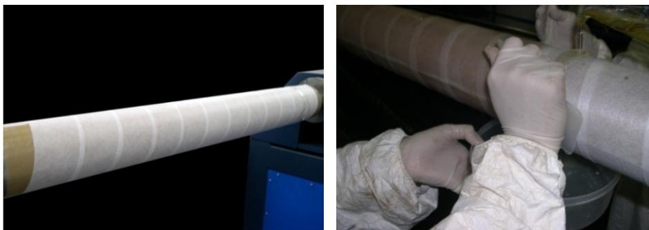
**Figura 35 – Aplicação do véu sobre o teflon (esquerda) e aplicação de resina sobre o véu (direita).**
