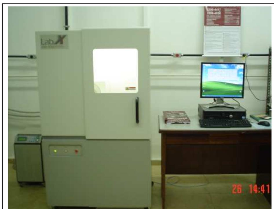
Figura 3.4 – Difratorômetro de Raios X Shimadzu XRD-6000
