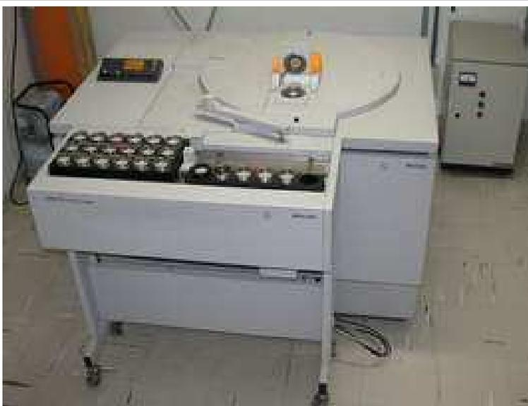
Figura 3.5 – Fluorescência de Raios X Philips modelo PW 2510 Sample Changer.
