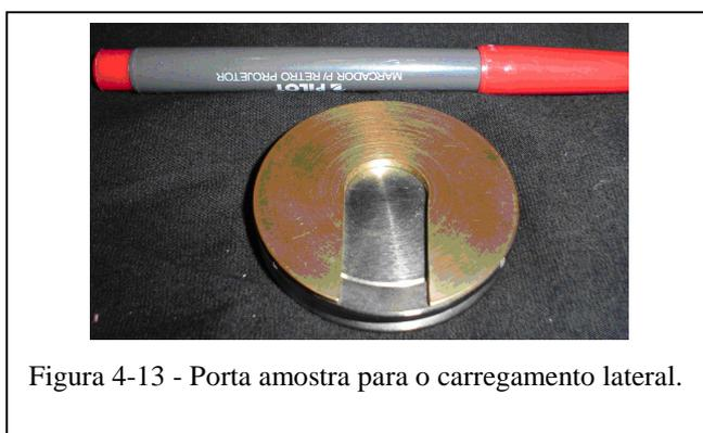
Figura 4-13 - Porta amostra para o carregamento lateral.
