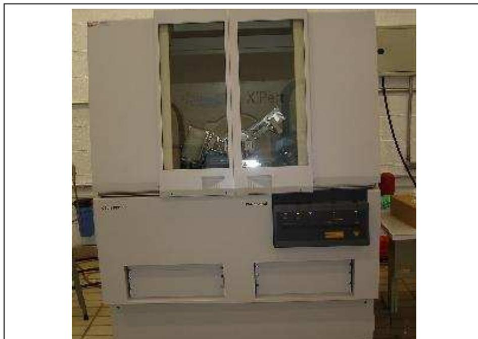
Figura 3.3 – Difratorômetro PANALYTICAL, X'PERT PRO.
