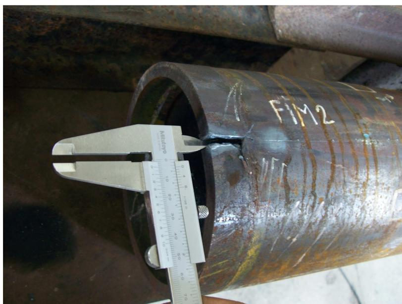
Figura 37 – Medição da perda do material pelo processo de oxi-corte.
