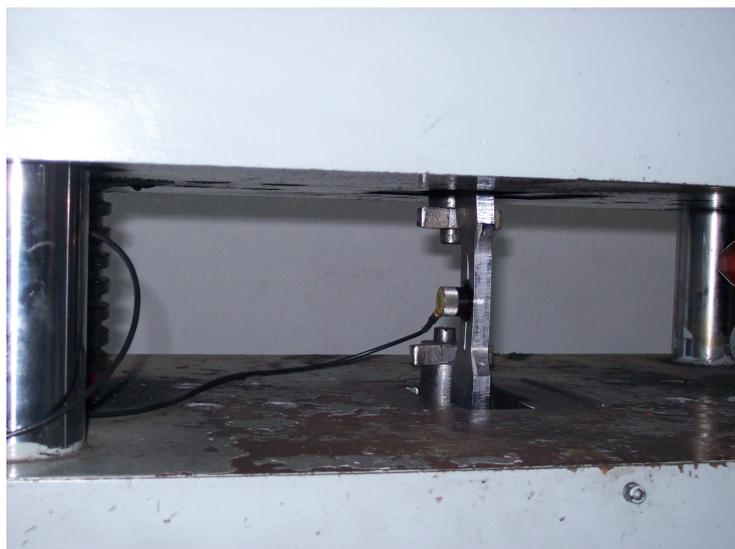
Figura 32 – Aquisição dos tempos de onda durante o carregamento.
