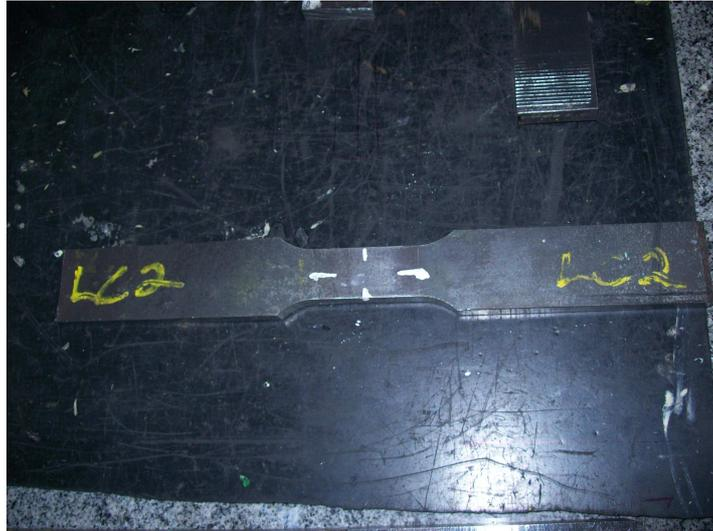
Figura 31 – Corpo-de-prova para levantamento da constante acustoelástica.
