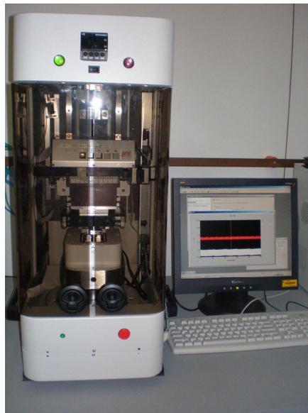
Figura 3.3 - Tribômetro utilizado como ensaio de riscamento “scratch test”.
