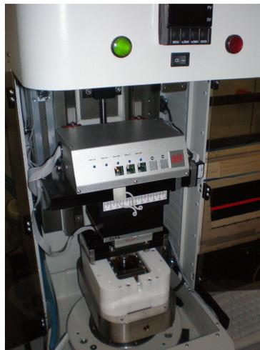
Figura 3.9 - Tribômetro com deslizamento “reciprocating” (pino-sobre-plano).
