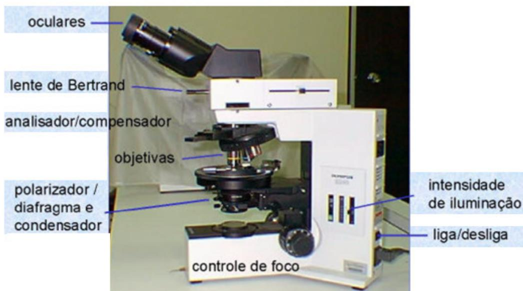
Figura 31 – Microscópio Ótico Olympus utilizado nas análises morfológicas
