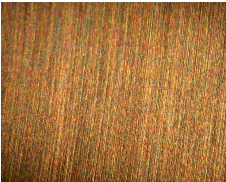
Figura 4: Aparência do corpo-de-prova do aço inoxidável UNS S32760 antes da realização dos ensaios de polarização anódica
