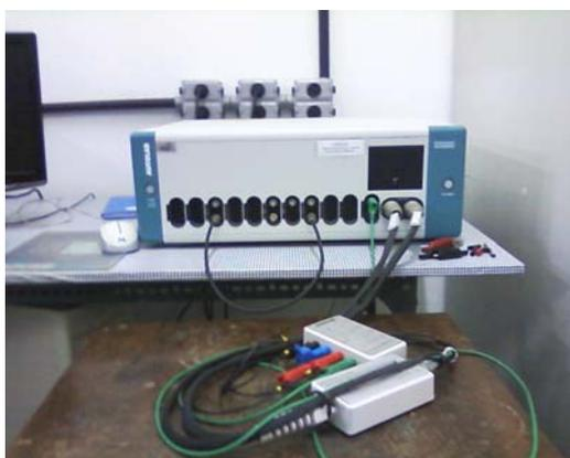
Figura III.1: Potenciostato AUTOLAB utilizado nos ensaios eletroquímicos
