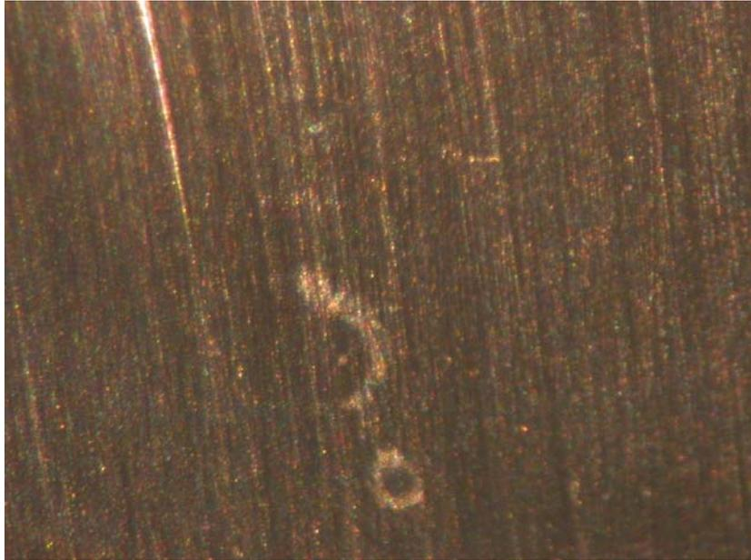
Figura 5: Aparência do corpo-de-prova do aço inoxidável UNS S31600 após realização dos ensaios de polarização anódica em solução de água do mar sintética com 150000 ppm de íons cloreto, temperatura de 80 °C e presença de CO<sub>2</sub>
