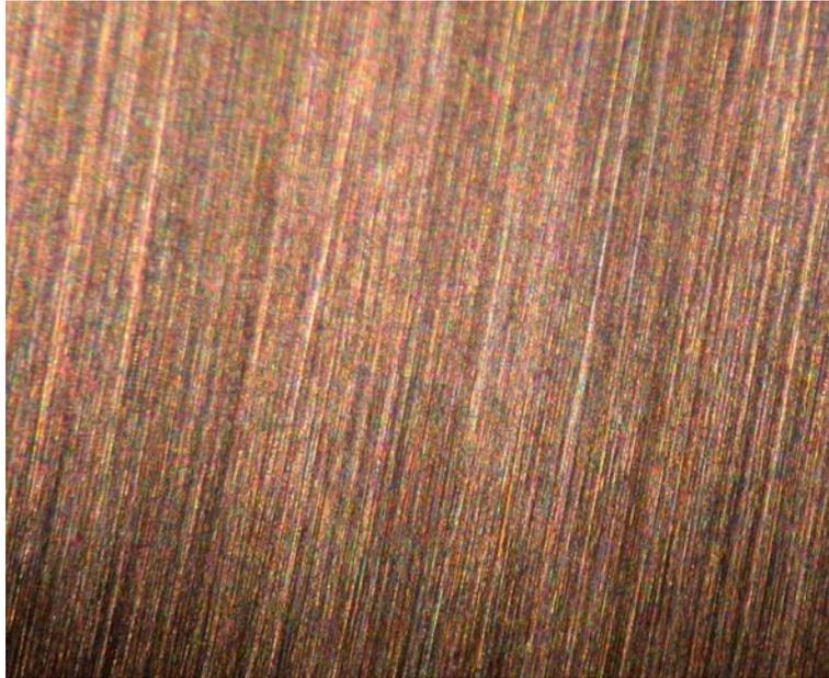
Figura 2: Aparência do corpo-de-prova do aço inoxidável UNS N08904 antes da realização dos ensaios de polarização anódica
