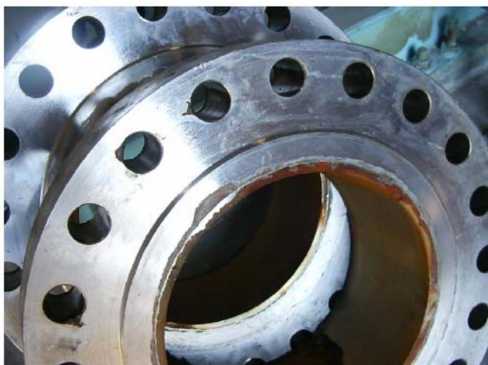
Figura II.6: Corrosão de flange constituída de aço inoxidável superduplex utilizada em uma planta de dessalinização (FRANCIS e BYRNE, 2007)
