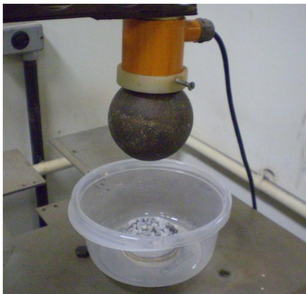
**Figura III-6. Célula de carga de impacto de 63 mm com acessórios para o ensaio de quebra de leitos por impacto com bola.**
