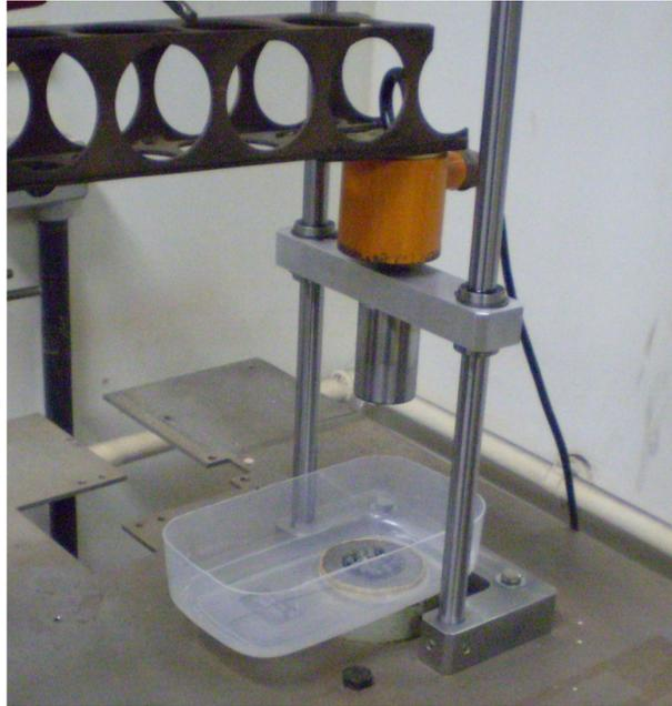
**Figura III-5. Célula de carga de impacto de 63 mm com acessórios para o ensaio de quebra de leitos por impacto com barra.**
