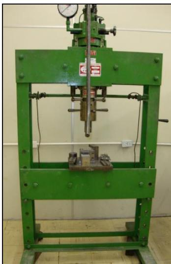
Figura 9: Prensa hidráulica uniaxial.
