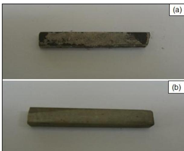
Figura 27: Coloração cinza claro observada na superfície das amostras do SiC-SFL-pn após 30 h imersas em (a)  $H_2SO_4$  e (b)  $NaOH$ .
