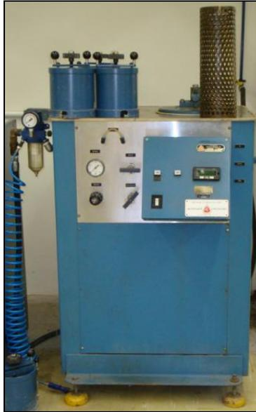
Figura 10: Prensa isostática.
