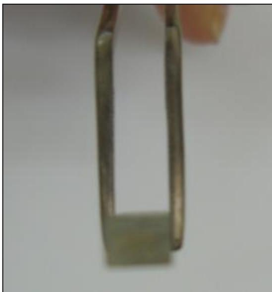
Figura 28: Coloração cinza claro observada no interior da amostra do SFL-pn após 30 h imersa em  $H_2SO_4$
