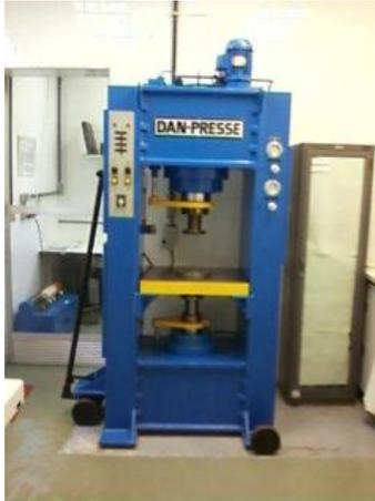
Figura 20 – Prensa hidráulica uniaxial, marca DAN PRESSE modelo DE-63x31,5.
