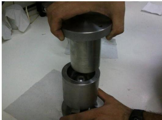
Figura 21 – Montagem do molde utilizado.
