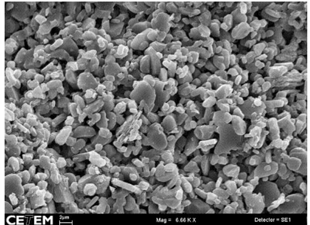
Figura 38 – Fratografias obtidas para as peças sinterizadas pelo ciclo térmico II para a) composição A e b) composição B.
