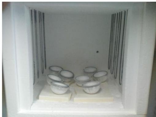
Figura 29 – Disposição das peças no forno.
