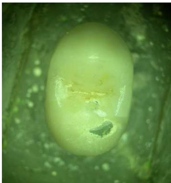
Figura 34 – Fratura em coroa metalocerâmica sob carregamento monotônico lateral na cúspide palatina.
