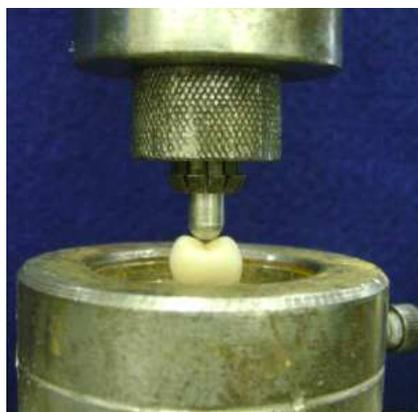
Figura 20 – Posicionamento do indentador (carregamento fisiológico) no corpo de prova.
