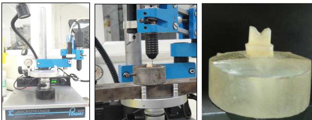
Figura 9 – (a) Fresadora (Microtenctor Blue Power – Laboratório Indent) (b) Sequência de desgaste inicial realizado com Ponta KGSorensen n°3217 e 4138, delimitando a espessura e o término do preparo (c) Demonstração do preparo intermediário.
