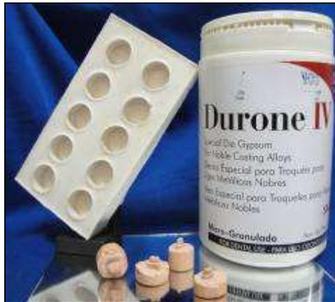
Figura 13 – Dispositivo de silicone confeccionado para a obtenção dos modelos de gessos, com base cilíndrica. Modelos confeccionados com gesso especial tipo IV.
