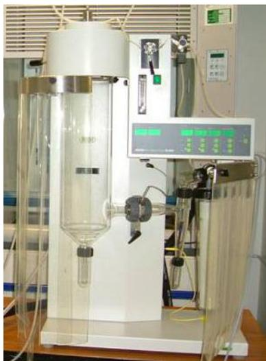
Figura 3.1 Equipamento para realizar secagem por spray drying. Adaptado de [www.ul.ie/web](http://www.ul.ie/web) (acessado em 10 de dezembro de 2010).
