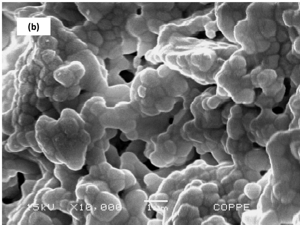
**Figura 5.21** – Microscopia das superfícies dos grânulos de CaP antes (a) e após imersão em Acetato por 7 horas sob condição estática.
