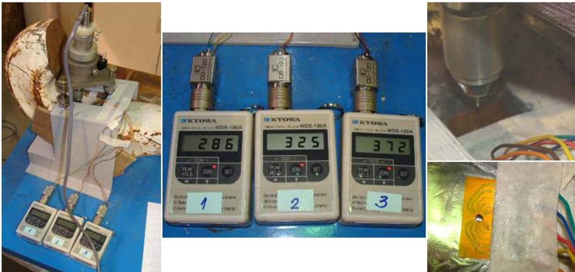
Figura 3.38 – Medição das tensões residuais no ponto B: dispositivos, furação, roseta de *strain gages* com o furo cego, medição das deformações  $\varepsilon_1$ ,  $\varepsilon_2$ ,  $\varepsilon_3$ .
