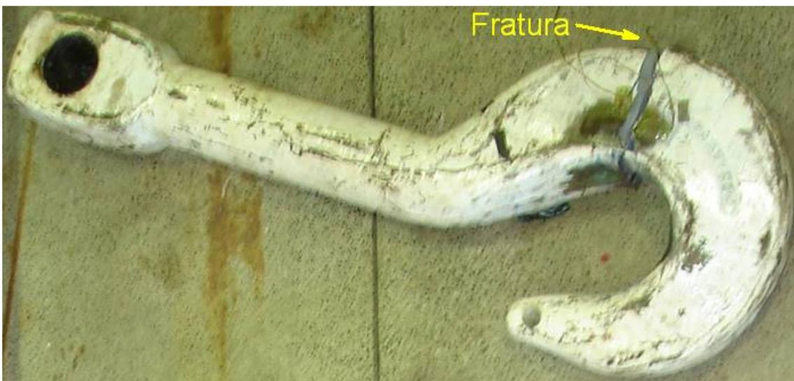
Figura 3.26 – Visão geral do gancho 9 fraturado.
