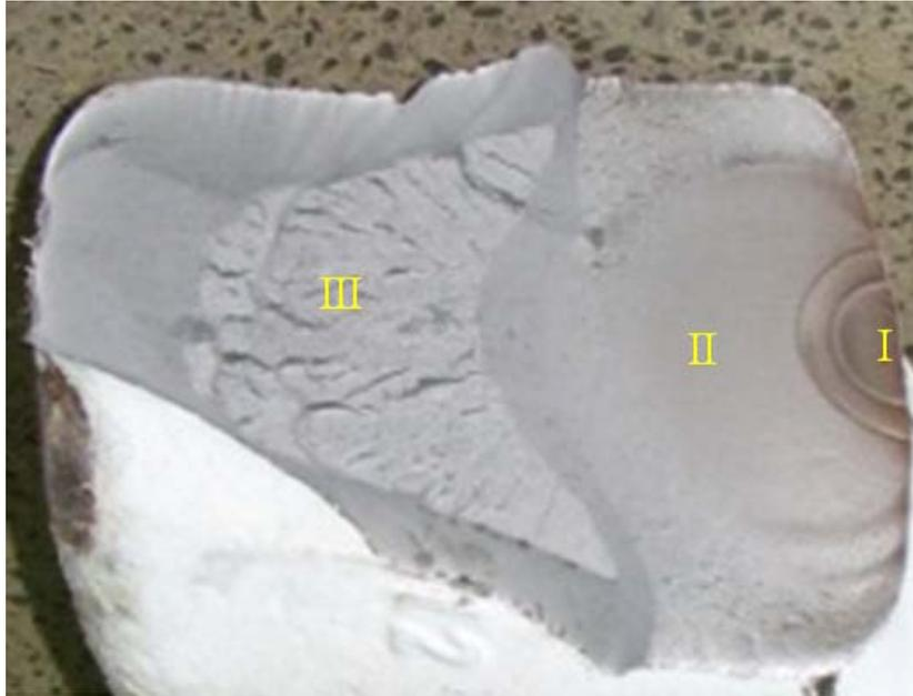
Figura 3.33 – Superfície da fratura por fadiga do gancho 11 (referente ao lado do corpo).
