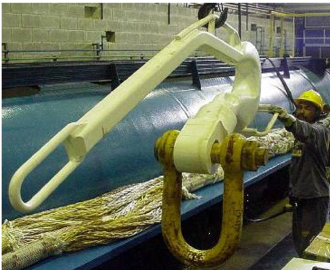
Figura 1.18 – Gancho KSDIN32 em escala real testado no Cenpes.
