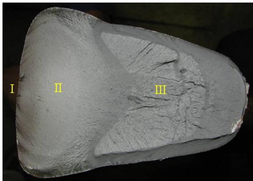
Figura 3.24 – Superfície da fratura por fadiga do gancho 8 (referente ao lado do corpo).
