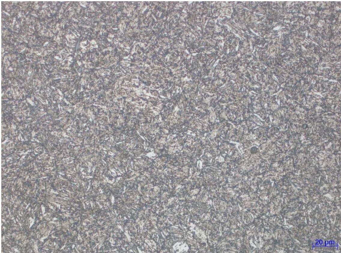
Figura 3.49 – Microestrutura da Amostra 6A. Martensita Revenida. Dureza: 298 HBs.
