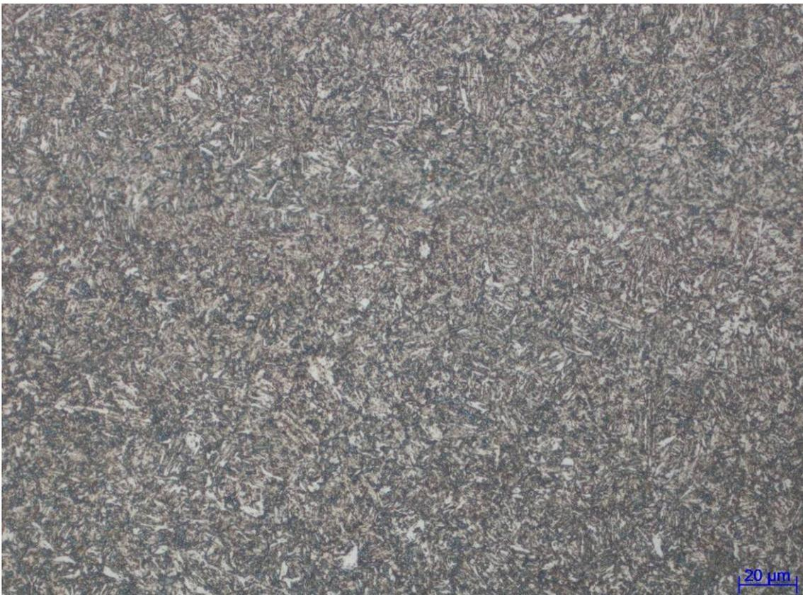
Figura 3.51 – Microestrutura da Amostra 6C. Martensita Revenida. Dureza: 296 HBs.
