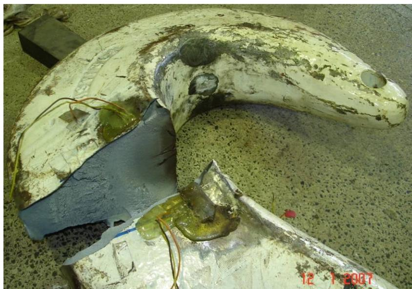
Figura 3.27 – Detalhe da fratura por fadiga do gancho 9.
