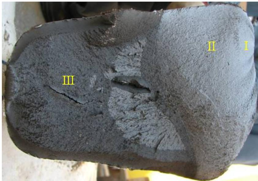
Figura 3.30 – Superfície da fratura por fadiga do gancho 12 (referente ao lado do corpo).
