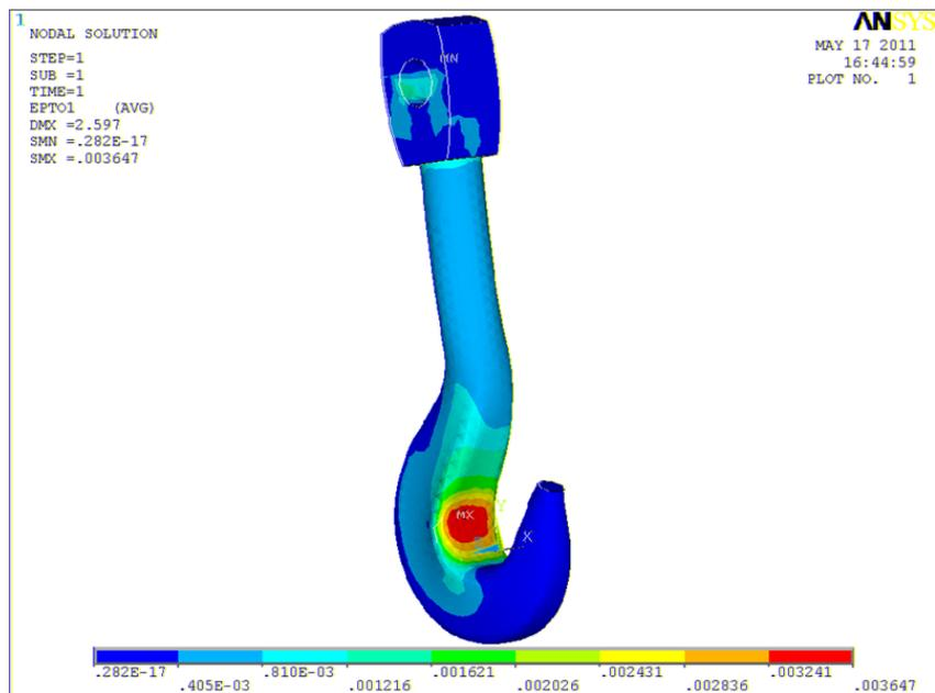
Figura 3.17 – Deformação principal linear máxima com 20% da carga dinâmica [3].
