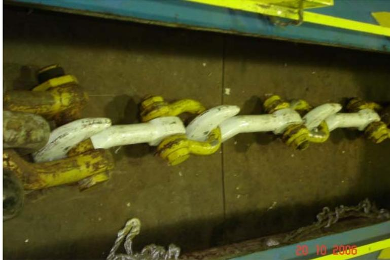
Figura 3.22 – Arranjo geral dos ganchos montados na máquina do CENPES.
