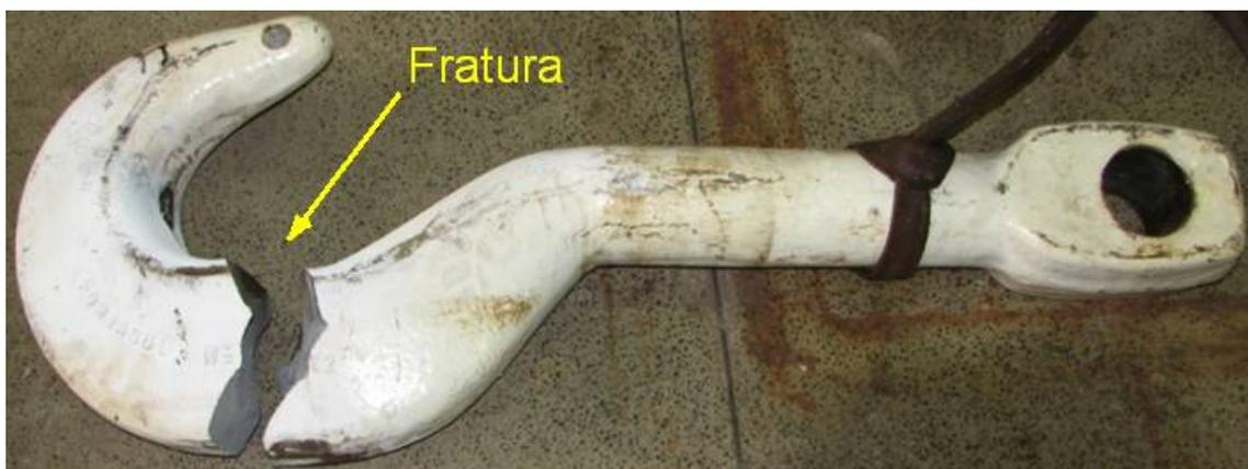
Figura 3.32 – Visão geral do gancho 11 fraturado.
