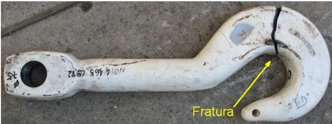
Figura 3.29 – Visão geral do gancho 12 fraturado.
