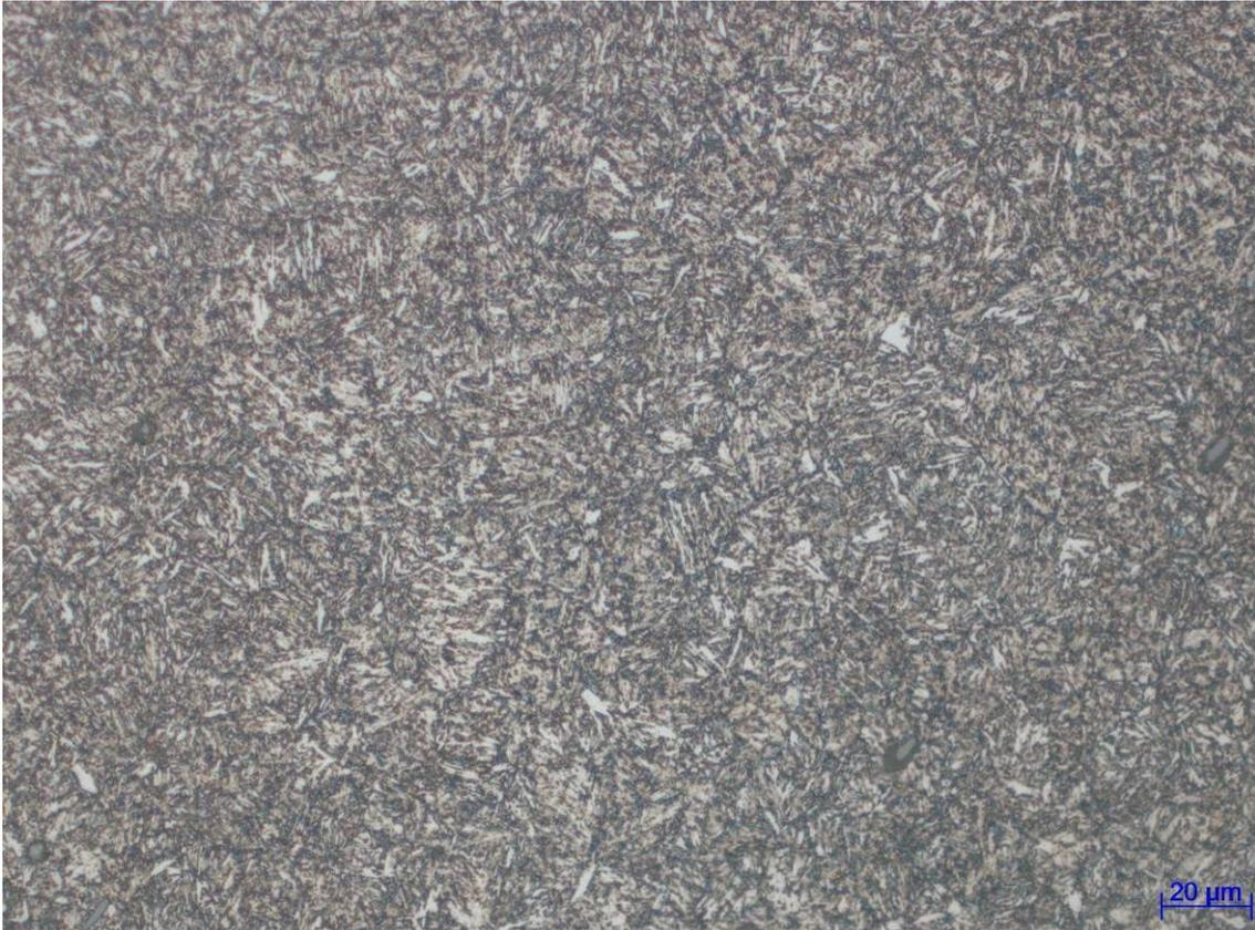
Figura 3.50 – Microestrutura da Amostra 6B. Martensita Revenida. Dureza: 298 HBs.
