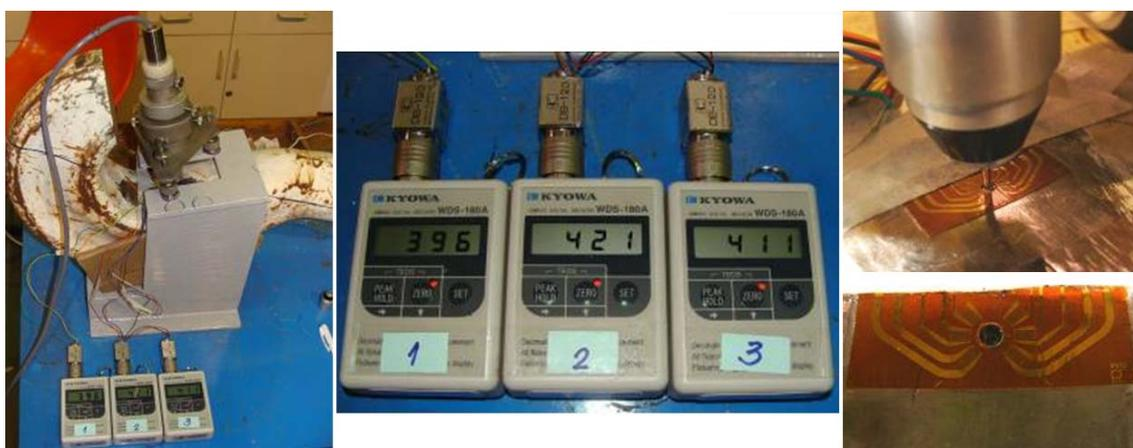
Figura 3.37 – Medição das tensões residuais no ponto A: dispositivos, furação, roseta de *strain gages* com o furo cego, medição das deformações  $\varepsilon_1$ ,  $\varepsilon_2$ ,  $\varepsilon_3$ .
