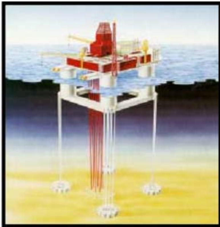
Figura 1.4 - Ilustração de uma plataforma TLP [1]
