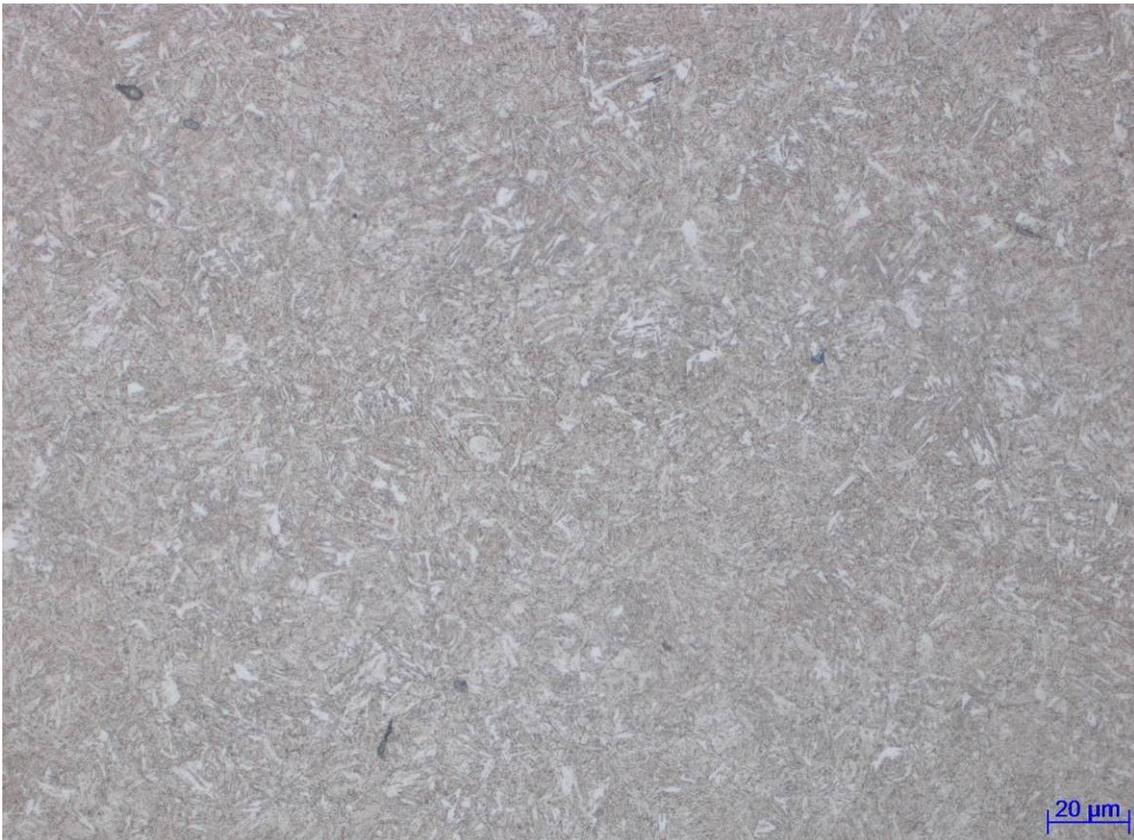
Figura 3.42 – Microestrutura da Amostra 1A. Martensita Revenida. Dureza: 299 HBs.
