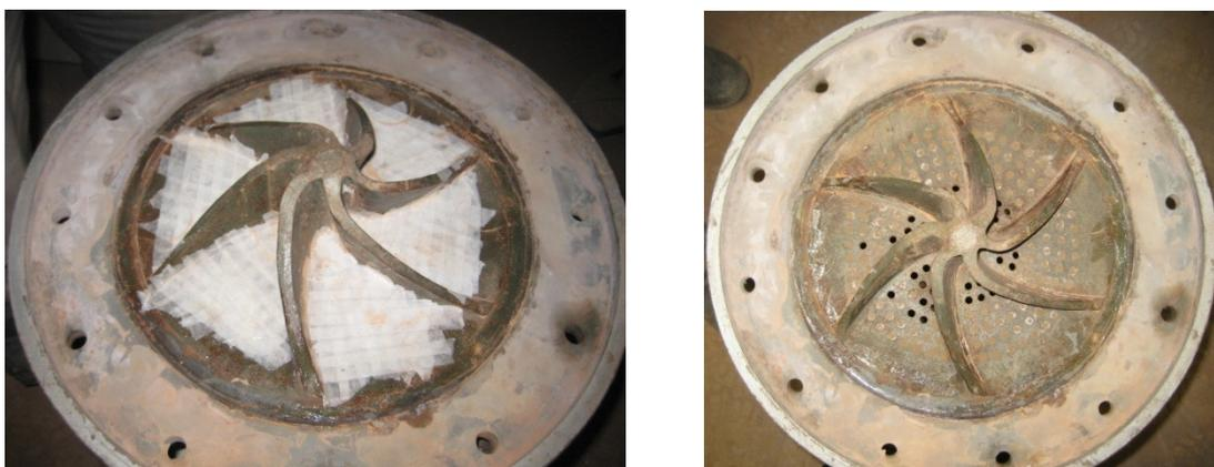
**Figura III-8 – Vista do diafragma antes (à esquerda) e depois (à direita) do ensaio de moagem descontínua.**
