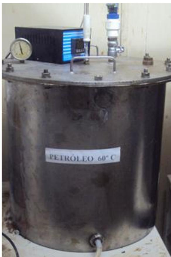
**Figura 41** Reator usado para envelhecimento do PVDF em Petróleo, durante 4 meses de exposição a 60 °C.
