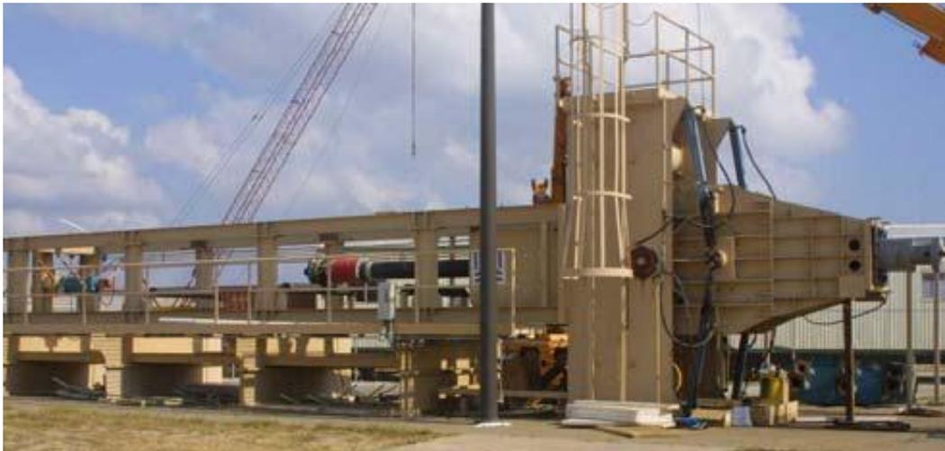
**Figura 18** Equipamento projetado para testes de tração, flexão e fadiga. Posição de trabalho horizontal - Wellstream [4].
