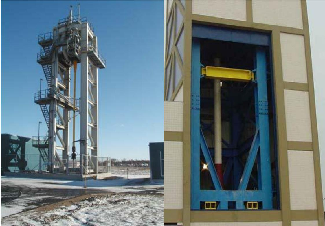
**Figura 19** Equipamento projetado para testes de tração, flexão e fadiga. Posição de trabalho vertical - NKT e COPPE [4].
