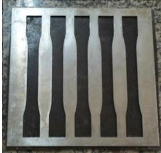
**Figura 39** Molde utilizado para obtenção dos corpos de prova tipo I com dimensões segundo ASTM D-638 [43].
