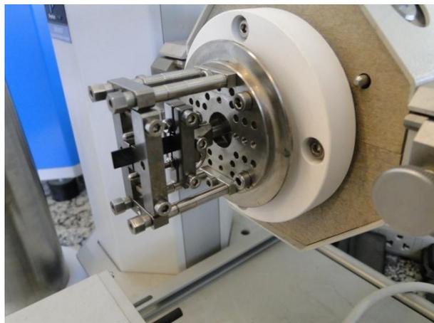
Figura 27 - Detalhe das garras móvel e fixa que prendem o corpo de prova para realização do ensaio de DMA pelo método de tração.
