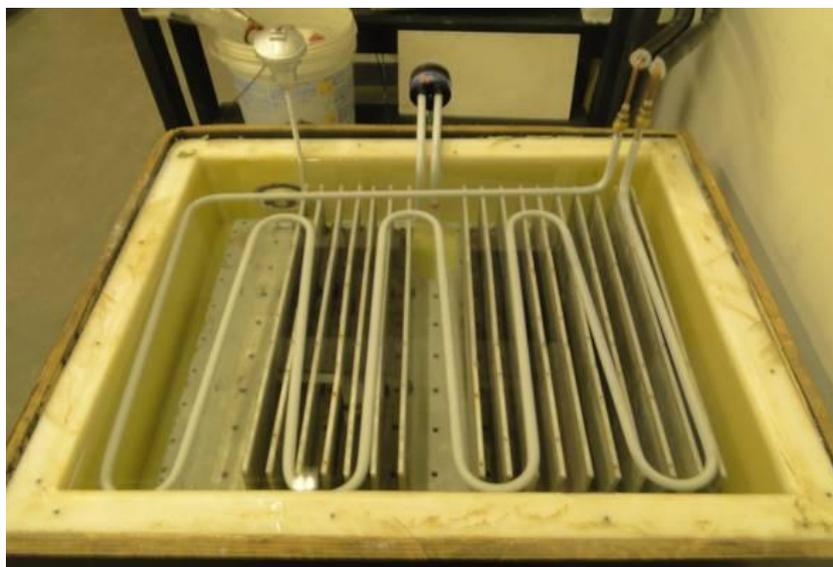
**Figura 21 - (a) Montagem experimental para a realização dos ensaios de ciclo térmico: 1 – Dispositivo de controle; 2 – Compressor com gás refrigerante; 3 – Água para reposição do nível de solução; 4 – Bóia para controle de nível da solução; 5 – Coifa para exaustão dos vapores durante o ciclo de aquecimento; 6 – Cuba com isolamento térmico. (b) Vista interna da cuba, com visualização dos espaços onde as amostras ficavam alojadas entre as aletas.**
