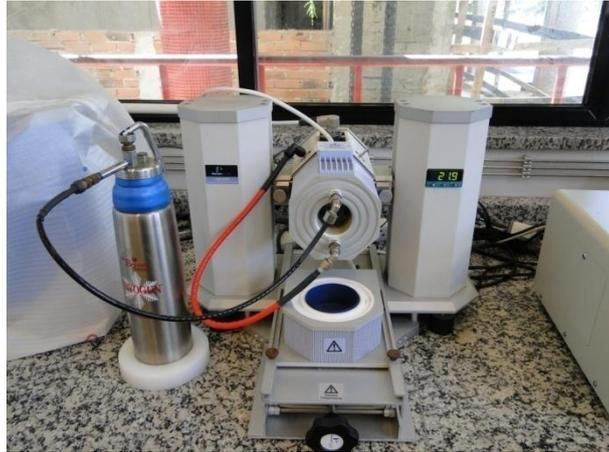
Figura 26 - Equipamento de DMA (Perkin Elmer 8000).
