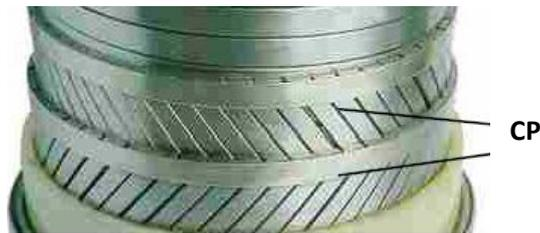
*Figura 19: Armaduras de Tração de um duto flexível [11]*
