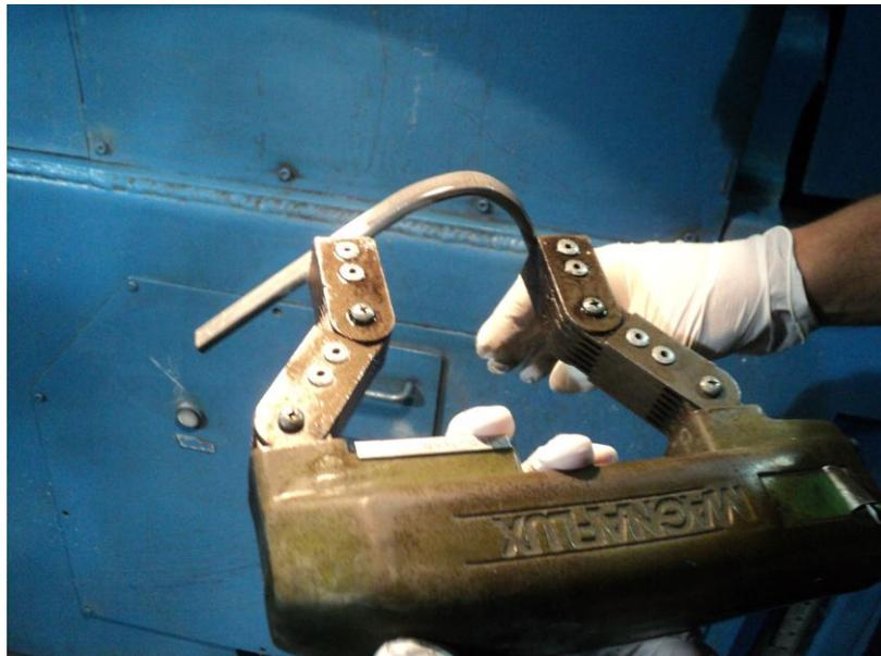
*Figura 42: Análise de partícula magnética após teste de dobramento.*
