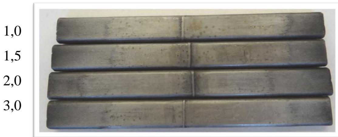
*Figura 58: Imagem das amostras, HIC-teste 3 — após do ensaio, 0,2% $H_2S$  com controle de pH.*
