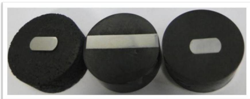
Figura 56: Imagem das amostras, HIC-teste 1 – após do ensaio, 0,2% $H_2S$  sem controle de pH.
