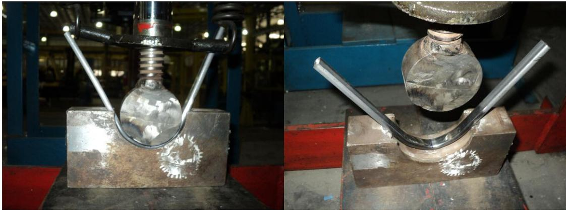
*Figura 41: Ensaio de dobramento.*
