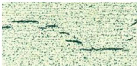
*Figura 16: Trinca induzida por hidrogênio [32].*
