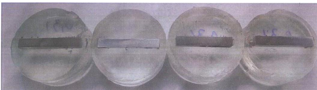
Figura 57: Imagem das amostras, HIC-teste 2 – após do ensaio, 0,3% $H_2S$  com controle de pH.
