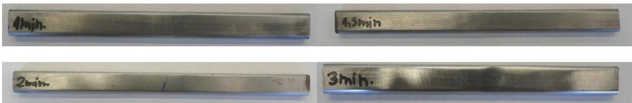
*Figura 33: Imagem dos corpos de prova, teste 3 – HIC – antes do ensaio, 0,2% $H_2S$  com controle de pH.*
