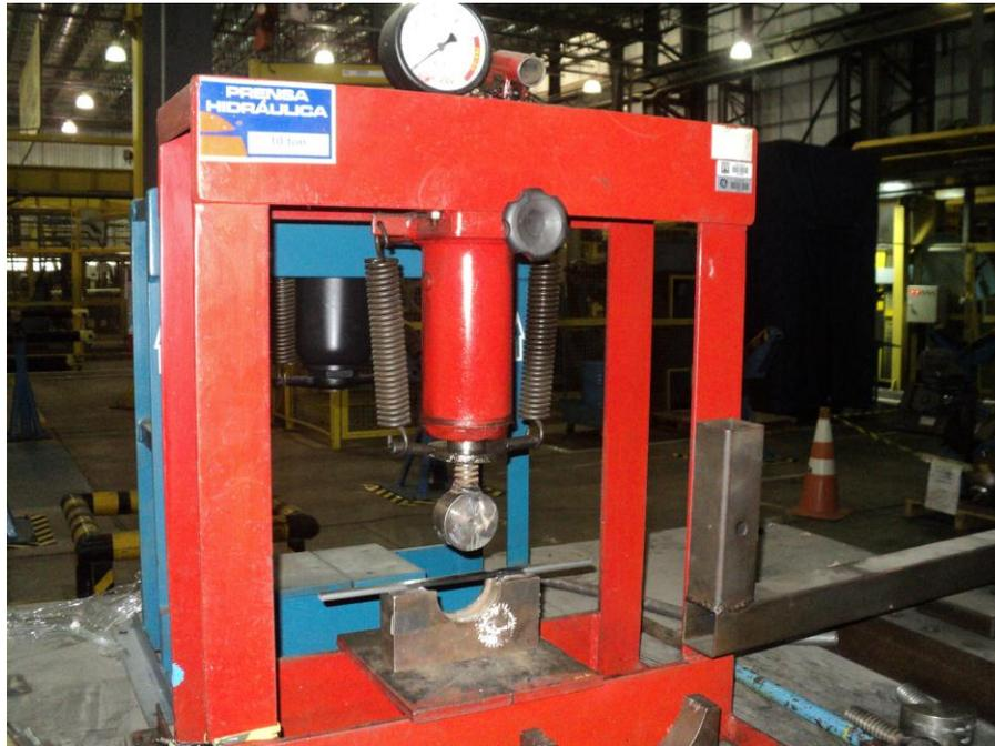
*Figura 21: Dispositivo utilizado para execução do teste de dobramento.*
