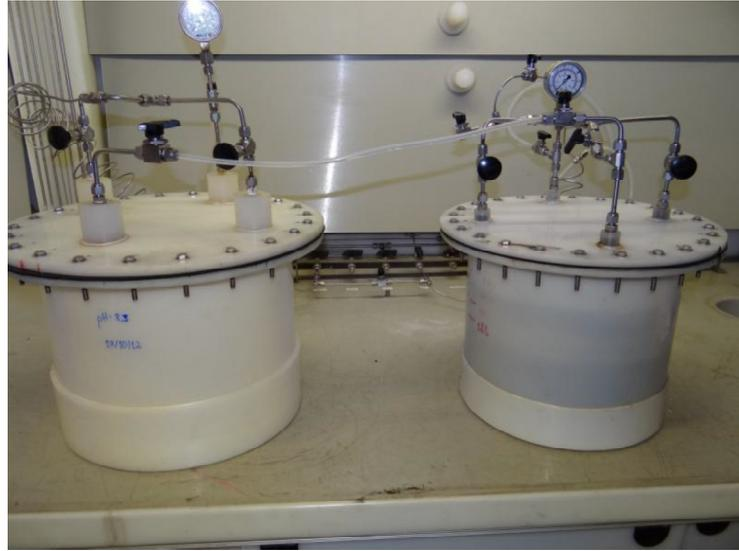
Figura 34 - Montagem do ensaio NACE TM 0284 [65].
