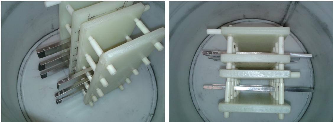
Figura 35 - Configuração das amostras submetidas ao ensaio NACE TM 0284. A esquerda vista isométrica. A direita vista de topo [65].
