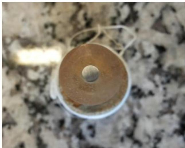
**Figura 23.** Eletrodo de disco rotatório.
