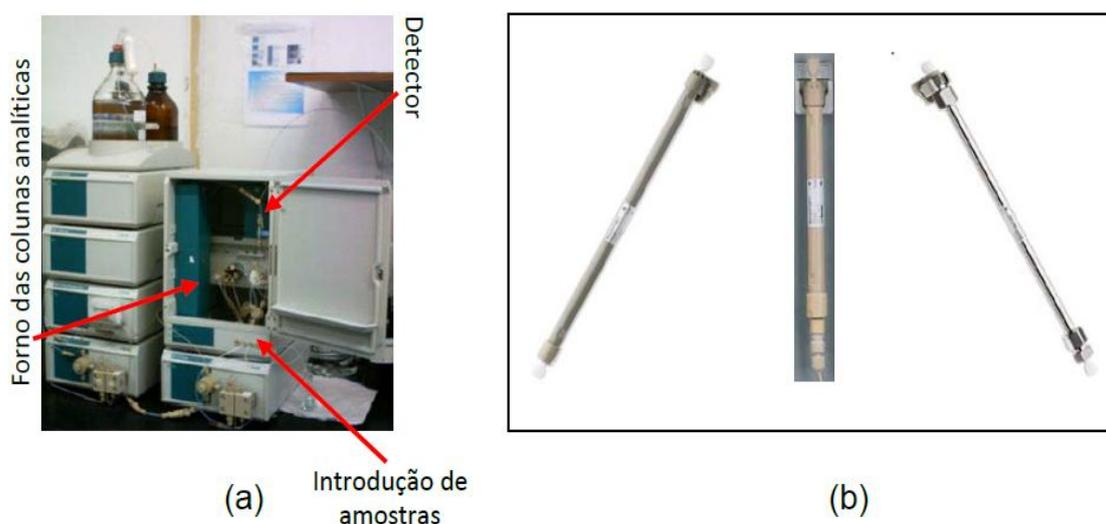
**Figura 19.** a) Cromatógrafo de íons modular Metrohm; b) colunas analíticas: MetroSep A Supp 5 250/4.0 mm, MetroSep Organic Acid 250/7.8 mm e MetroSep C2-150/4.0 mm, respectivamente.
