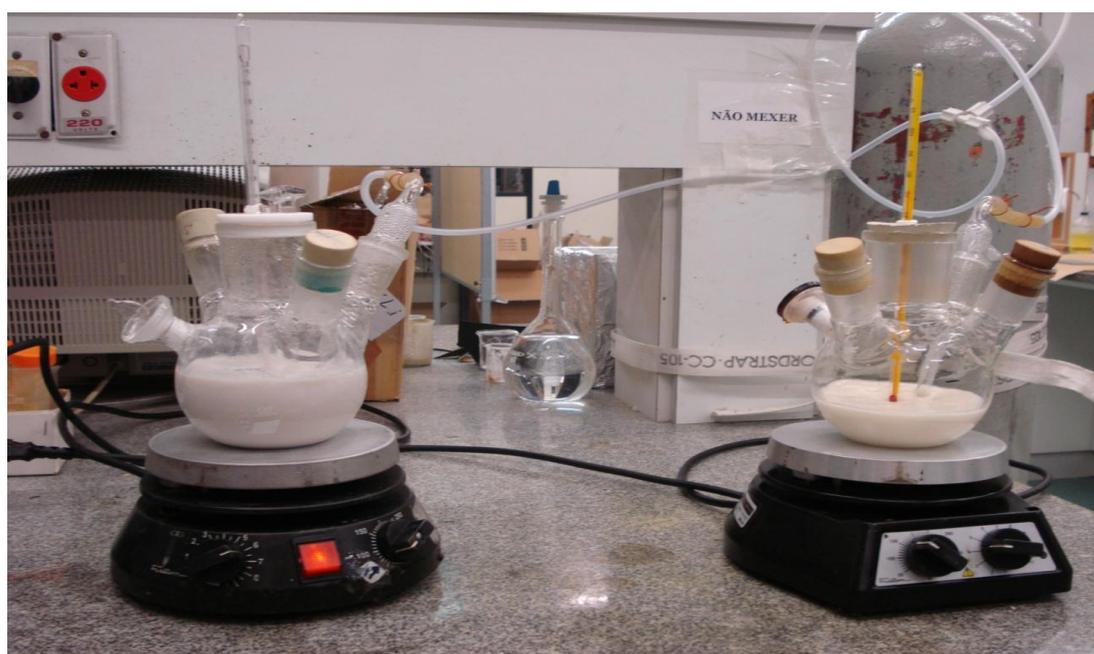
**Figura 15.** Aparato experimental utilizado na reconstrução lamelar.
