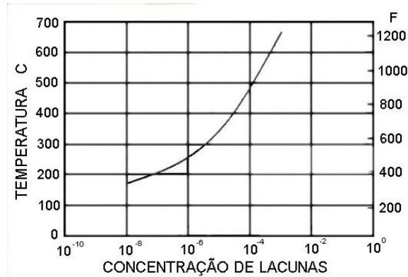
Figura 2.6 Concentração de equilíbrio de lacunas em alumínio puro em função da temperatura (HATCH, 1984, p. 139).
