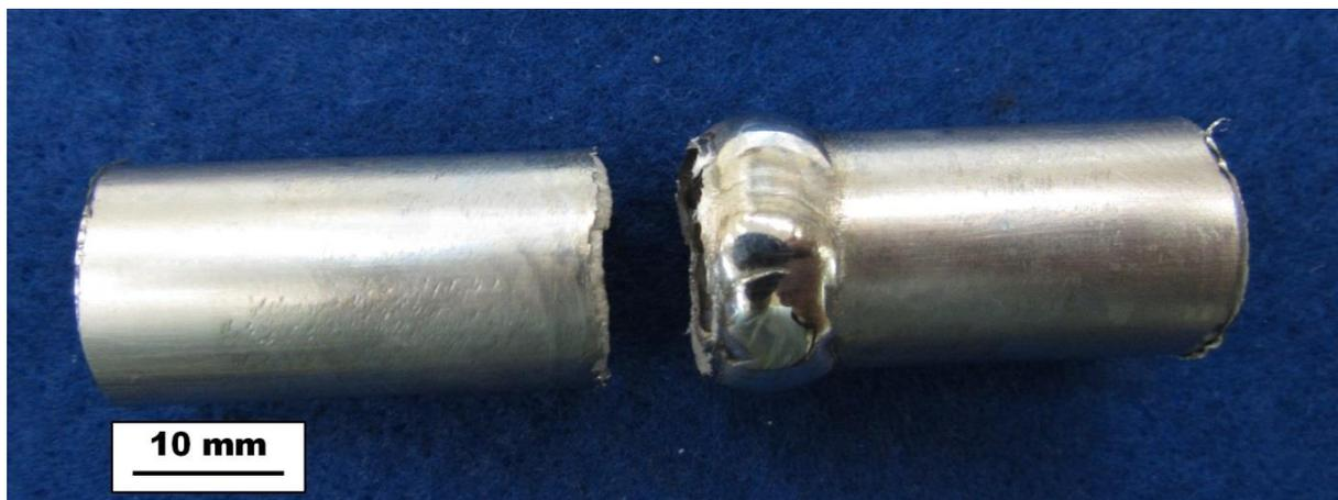
Figura 89 – Vista lateral da fratura do tubo soldado hidrogenado.
