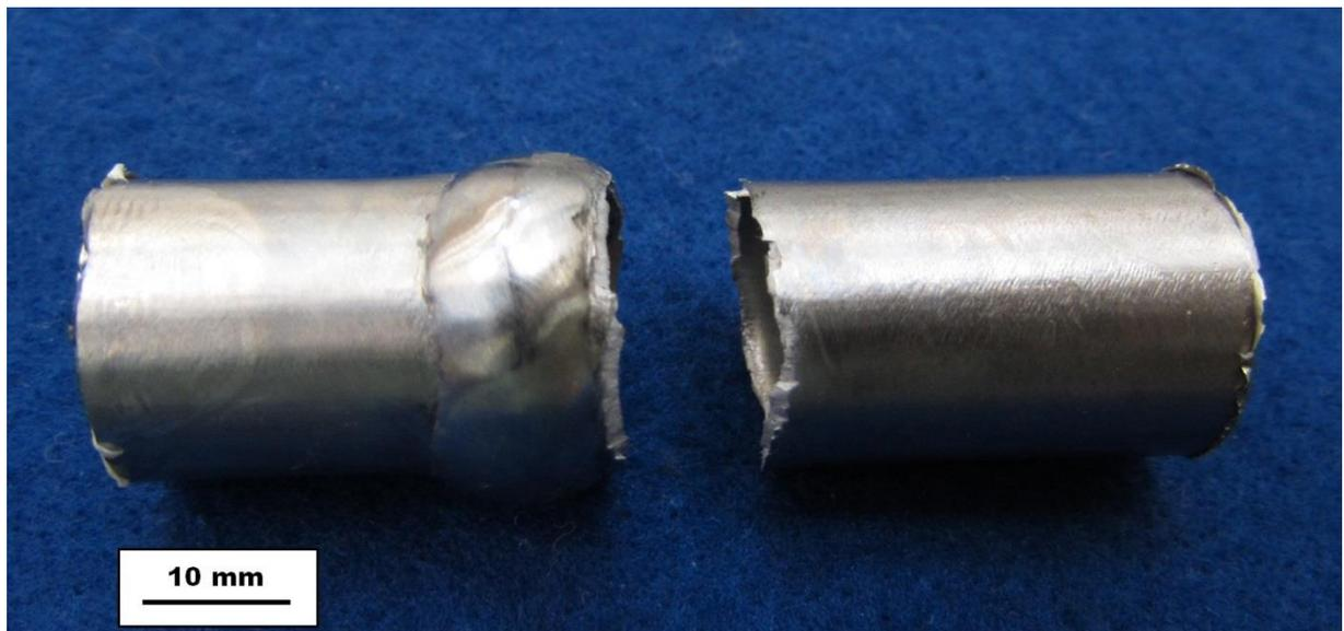
Figura 74 – Vista lateral da fratura do tubo soldado sem hidrogênio.
