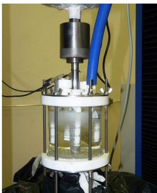
Figura 54 - Célula eletrolítica usada para hidrogenação dos tubos.
