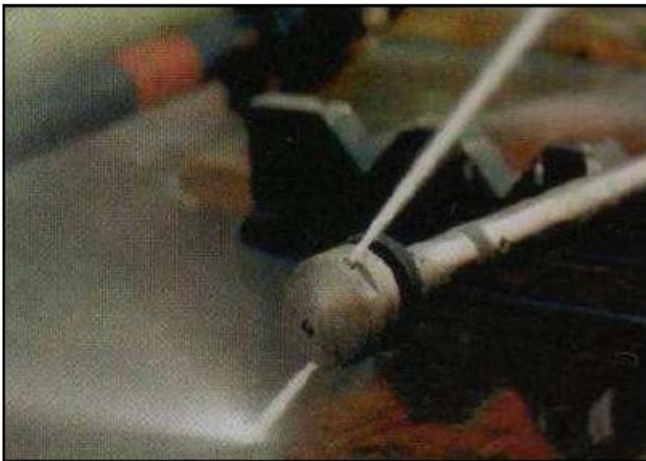
Figura 11: Equipamento utilizado no jateamento de incrustações em *topside* (adaptado de [22])
