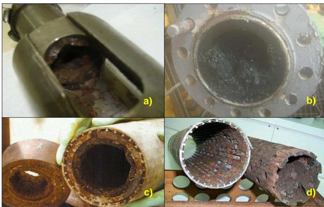
Figura 5: Ocorrências de incrustações em: a) válvulas; b) equipamento de superfície; c) colunas de poços de produção; e d) telas de *gravel Pack* (adaptado de [22])
