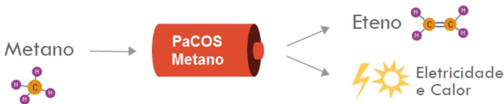
**Figura 7:** Esquema ilustrativo de um reator de membrana seletiva tipo PaCOS (adaptada da referencia 47).
