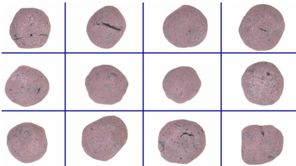
Figura IX.25 – Imagens de macroestrutura da pelota E mostrando aspectos superficiais
