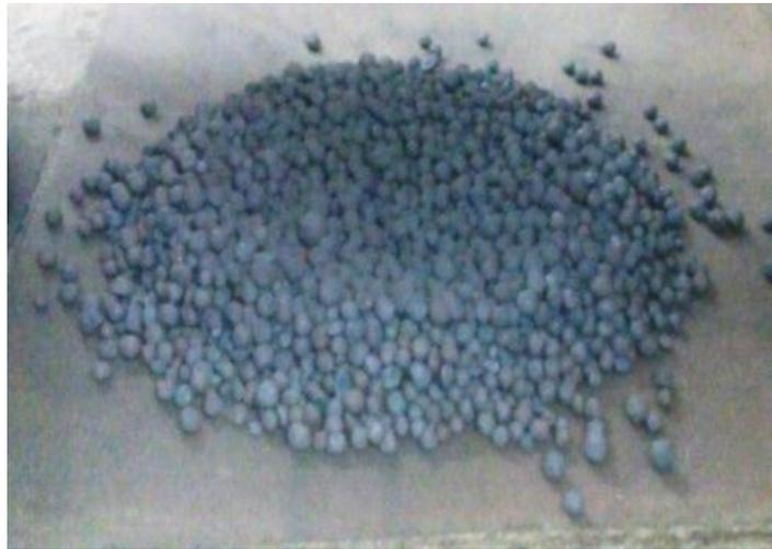
Figura IV.17 – Amostra após choque contra placa de aço no ensaio de simulação de manuseio
