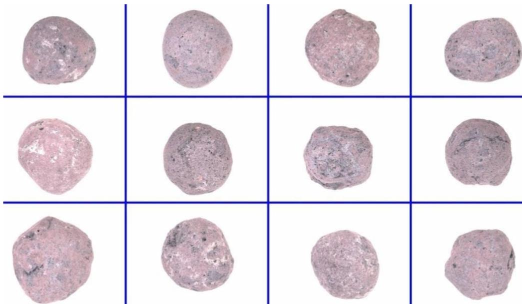
Figura IX.15 – Imagens de macroestrutura da pelota C mostrando aspectos superficiais
