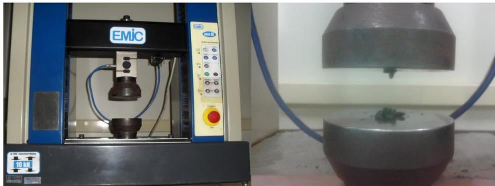
Figura IV.7 - Prensa de compressão EMIC com capacidade de 10kN
