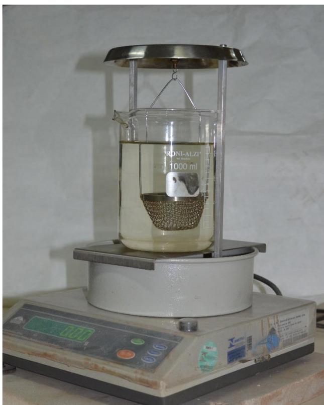
Figura IV.3 – Balança e medidor de densidade utilizados no ensaio de densidade hidrostática
