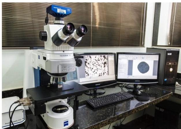
Figura IV.1 – Microscópio Óptico com software de análise de imagens acoplado onde foram obtidas imagens da microestrutura das pelotas
