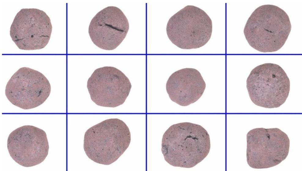
Figura V.10 – Imagens de macroestrutura de pelotas E, selecionadas, mostrando aspectos superficiais
