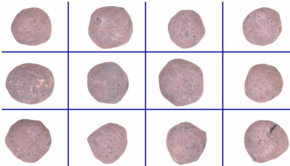
Figura IX.5 – Imagens de macroestrutura da pelota A mostrando aspectos superficiais
