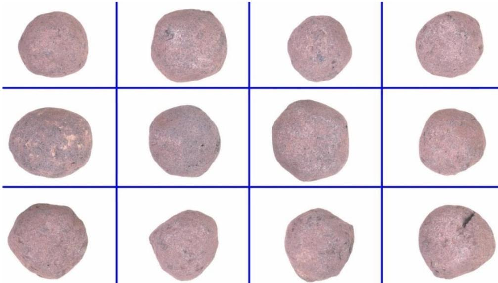
Figura V.9 – Imagens de macroestrutura de pelotas A, selecionadas, mostrando aspectos superficiais
