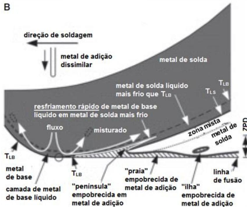
Figura 2.29. Formação de macrosegregação na linha de fusão (zona parcialmente diluída ZPD) quando metal de adição provoca  $T_{LS} < T_{LB}$ . A - praia; B - praia, península e ilha. Círculo denota frente de fusão na linha de fusão à esquerda e frente de solidificação à direita[62].
