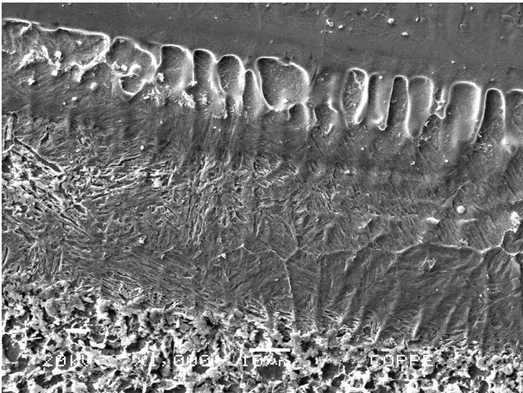
Figura 4.18. Região localizada em morfologia de "praia" apresentando microestrutura martensítica. Direção transversal. Aumento de 1000x. Ataque: Nítrico acético.
