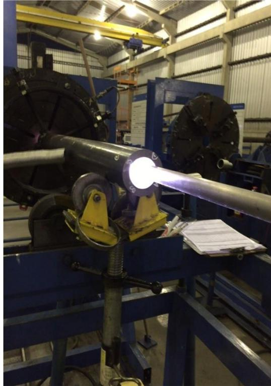
Figura 3.2. Soldagem de revestimento interno de tubo de aço carbono com liga de níquel-cobre 400 pelo processo GTAW-HW.
