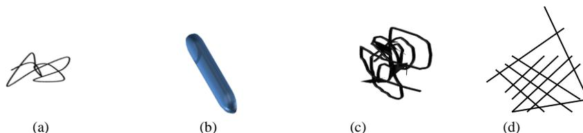
**Figura 20.** Representação esquemática de um polímero (a) Flexível, (b) Rígido, (c) e (d) suas soluções concentradas.
