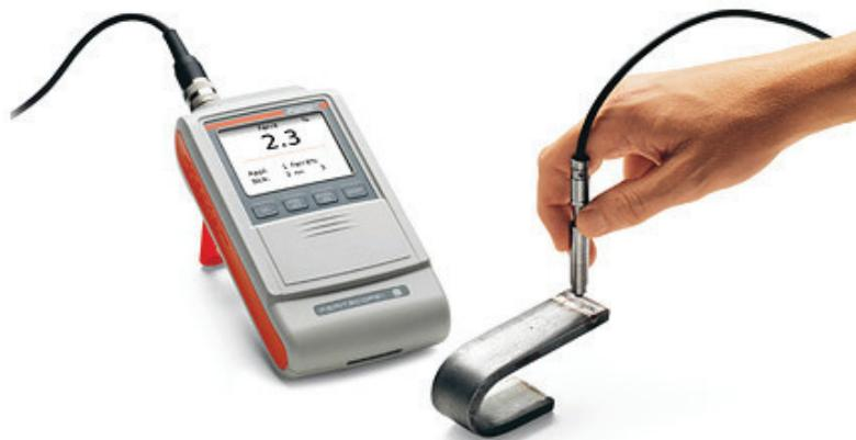
Figura 2.15. Ferritoscópio em operação. Na tela do aparelho é possível ler a fração de fase ferromagnética.
