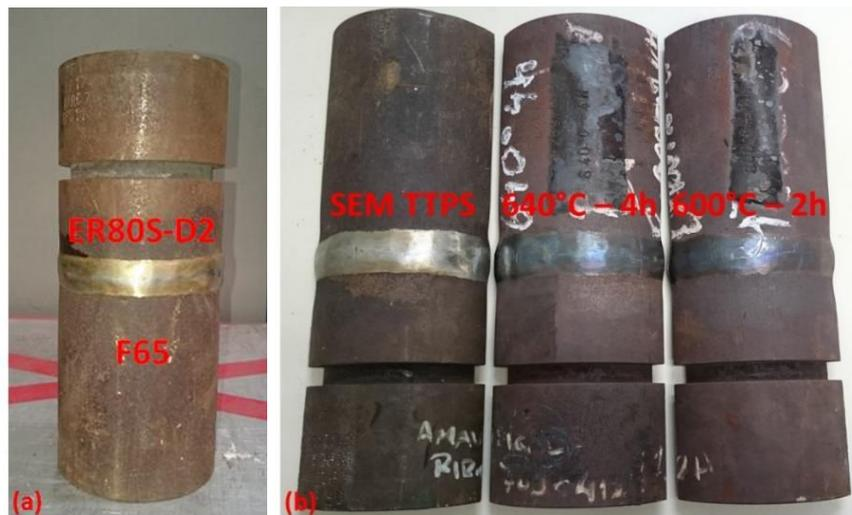
Figura 28 – (a) Corpo de prova de união entre ER80S-D2 e ASTM A694 F65; (b) corpos de prova serrados e dois deles submetidos a tratamento térmico pós-soldagem.
