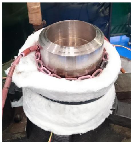
Figura 23 – Aquecimento do corpo de prova com resistência elétrica para solda de amanteigamento.
