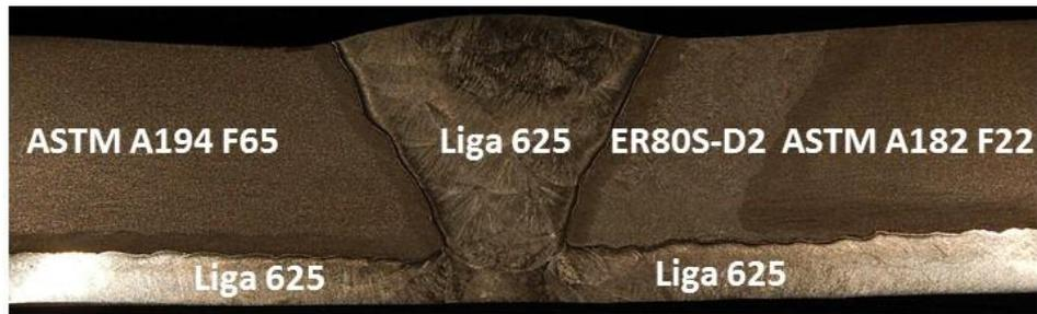
Figura 3 – Macrografia de uma junta de ASTM A182 F22 modificado amanteigado com ER80S-D2 e unido utilizando liga de níquel 625.
