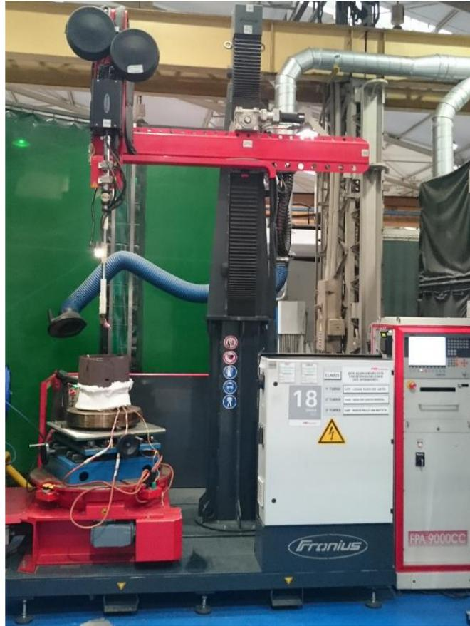
Figura 22 – Equipamento Fronius *hot wire* (software FPA9000), utilizado para soldagem de revestimento e amanteigamento.
