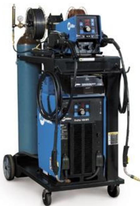
Figura 26 – Equipamento Miller Pipe Pro 450 utilizado para soldagem de união.
