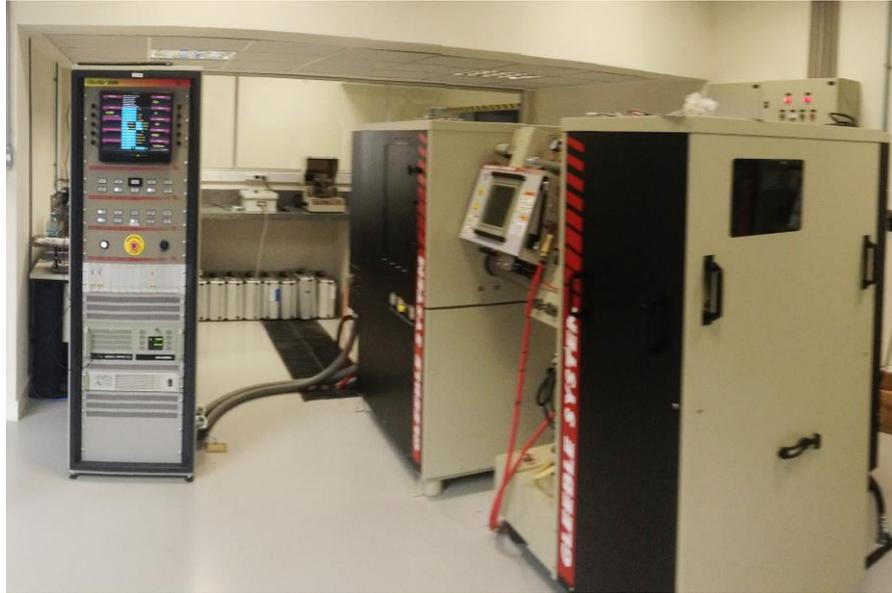
Figura 14: Equipamento Gleeble ® 3800, Cortesia CTS Solda.
