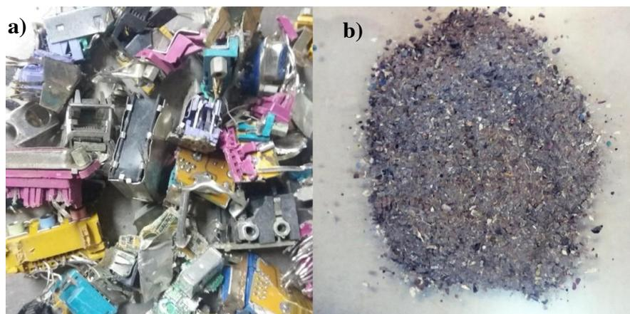
**Figura 9** – Aspecto do produto das PCI's após o separador magnético na corrente I (a) e na corrente II (b).
