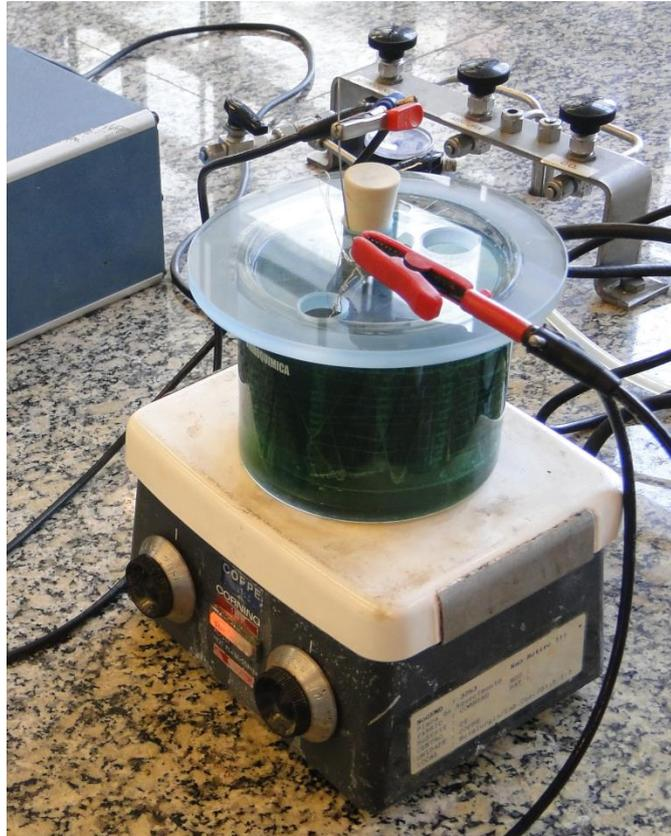
**Figura 2. 3 - Célula de eletrodeposição de níquel**
