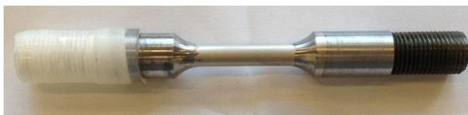
**Figura 2. 9 - Corpo de prova após a eletrodeposição de níquel**
