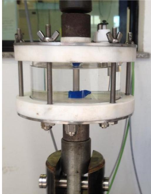
**Figura 2. 12 - Corpo de prova em célula BTD, isolado com fita líquida, ficando em contato com a solução de 1M de NaOH somente a região de interesse.**
