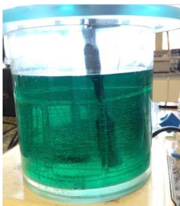
**Figura 2. 10 - Corpo de prova sendo revestido na célula eletroquímica.**
