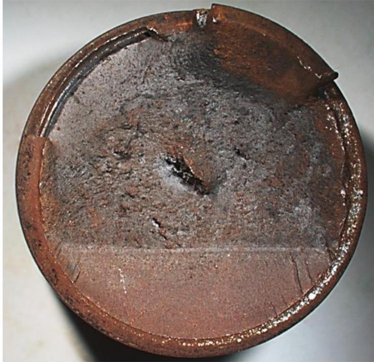
Figura 212 – Foto em lupa estereoscópica da superfície de fratura de um fixador ilustrando a região de propagação subcrítica em fadiga (parte reta inferior) e a região de propagação abrupta
