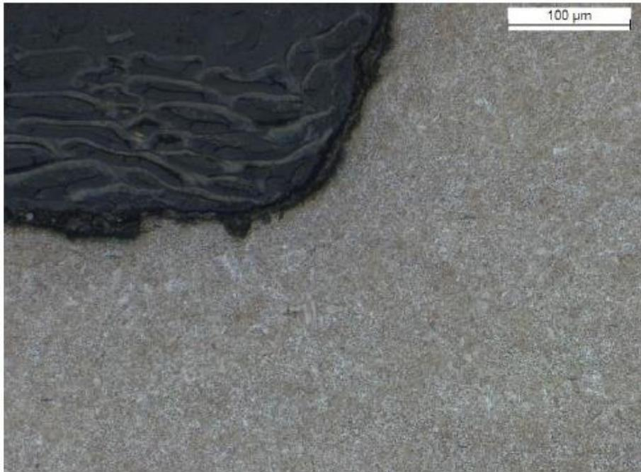
Figura 77 – Metalografia da região superficial em corte longitudinal.
