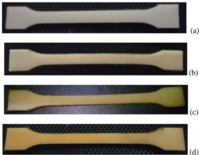
**Figura 8:**(a) Corpo de prova de PVDF não envelhecido, (b) Corpo de prova de PVDF envelhecido 30 dias, (c) Corpo de prova de PVDF envelhecido 90 dias e (d)Corpo de prova de PVDF envelhecido 180 dias
