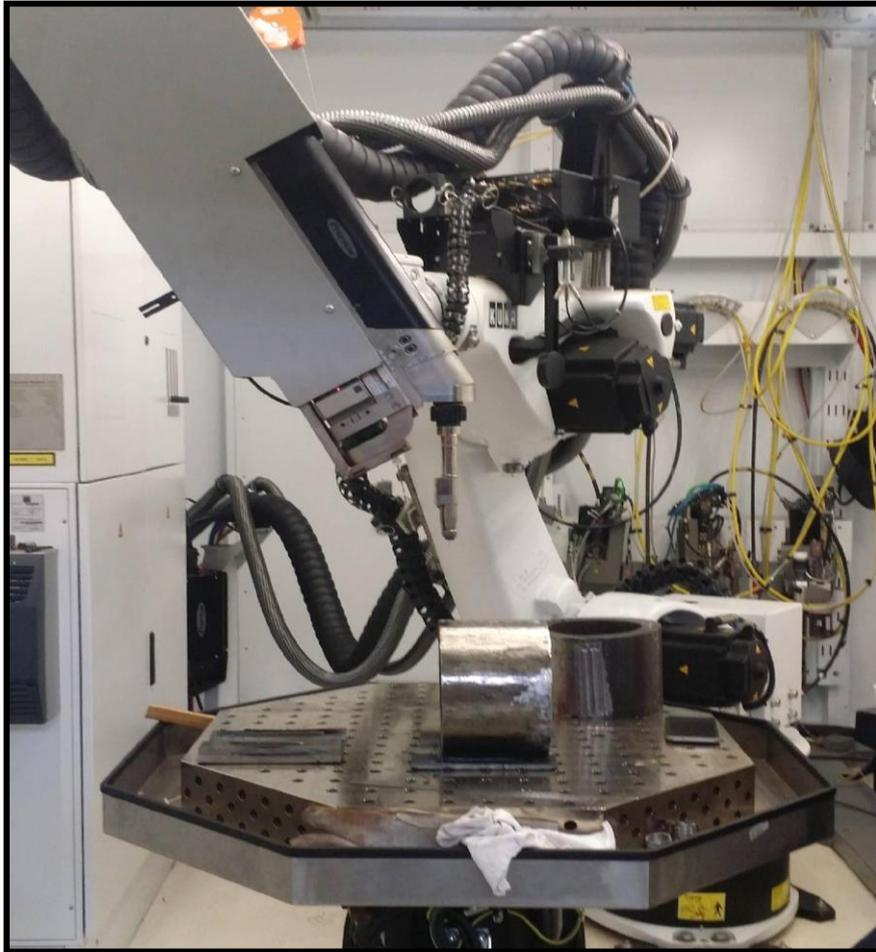
Figura 43. Equipamento de soldagem robotizada (Kuka)
