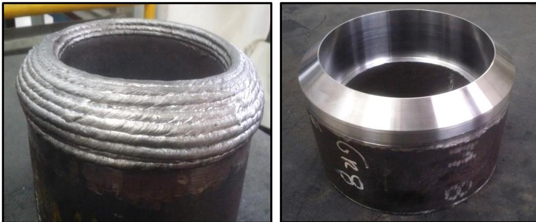
Figura 101. Bisel amanteigado antes e depois da usinagem.
