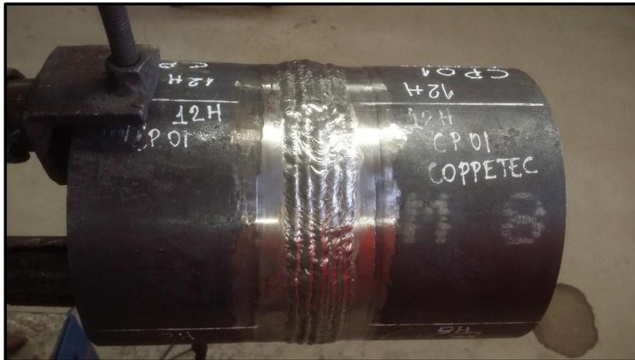
Figura 103. Junta amanteigada soldada.
