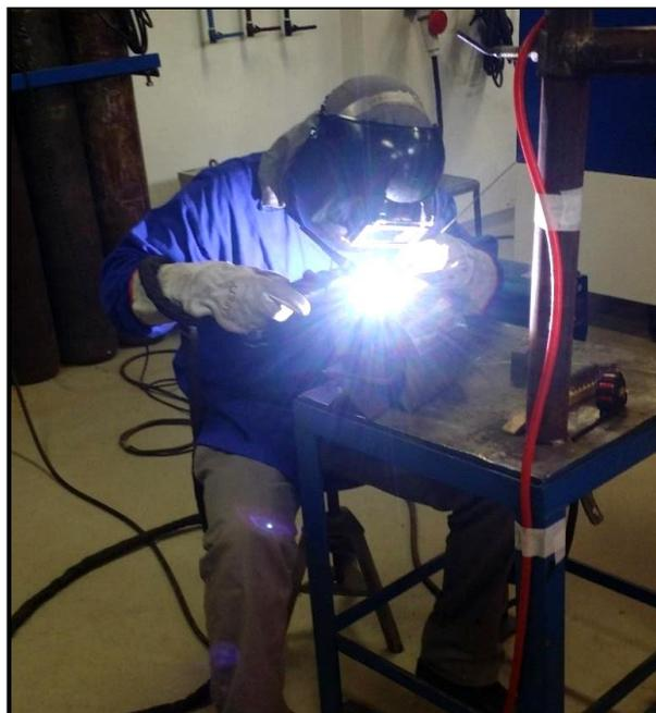
Figura 41. Soldagem com processo GTAW manual.
