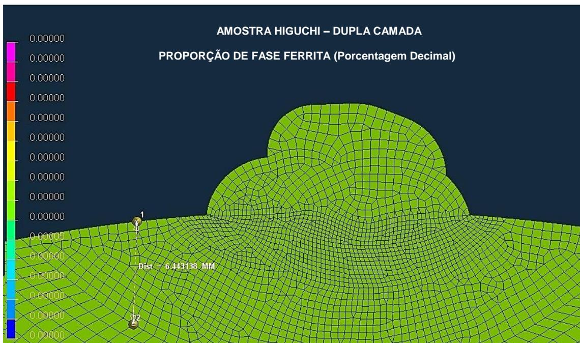
Figura 121. Simulação da distribuição de ferrita formada na ZTA do aço 9%Ni durante a soldagem dupla camada.
