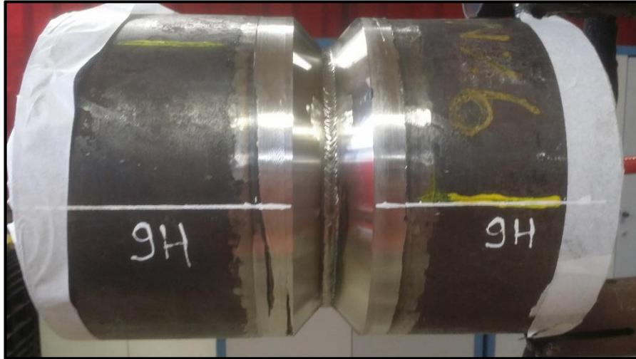
Figura 102. Passe de raiz da junta amanteigada.
