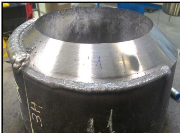
Figura 45. Teste Pré-Amanteigamento no chanfro em V.
