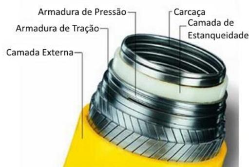
**Figura 3** Imagem de um *riser* flexível. Nesta figura observa-se as diversas camadas que compõe o *riser* flexível. Adaptado de [1].
