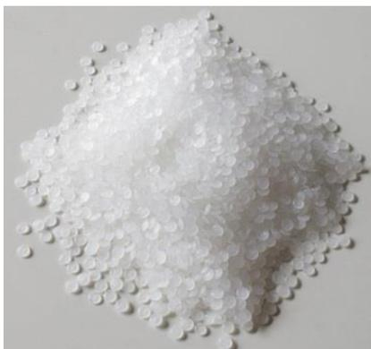
**Figura 24** Imagem de *pellets* de PVDF semelhantes aos utilizados neste trabalho. Neste trabalho foram utilizados dois tipos de *pellets* oriundos de dois diferentes fabricantes.
