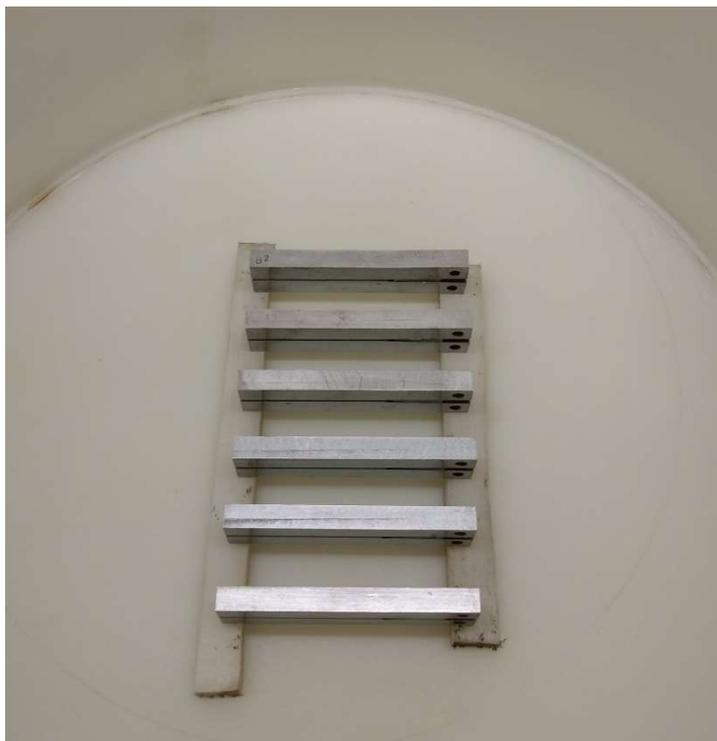
Figura 47 – corpos de prova dentro dos vasos.
