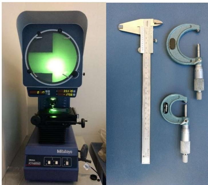
Figura 45 – projetor de perfis paquímetro e micrometro.
