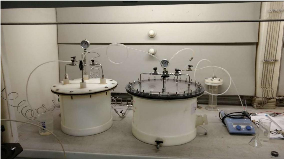
Figura 48 – vasos utilizados no ensaio, a direita o vaso com os corpos de prova e a esquerda o vaso utilizado para purgar a solução.
