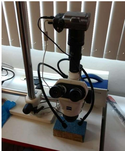
Figura 50 - lupa estereoscópica.
