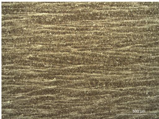
Figura 4.4: Bandas de segregação observadas em microscopia óptica na amostra somente temperada (T)
