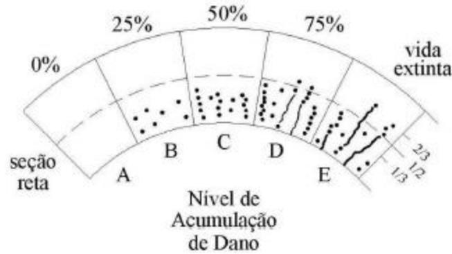
Figura 2. 7: Critério de avaliação de dano acumulado por fluência em tubos de reforma. Adaptado de (SILVEIRA, 2006).
