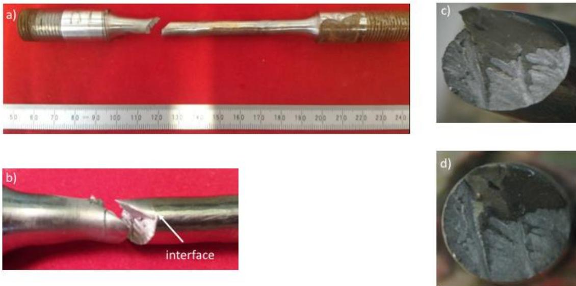
Figura 142 Análise pós-ensaio de BTB em corpo de prova extraído de junta tipo I, 20 horas de TTPS, ensaio 2 ao meio. a) Fotografia do CP após ensaio; b) Fotografia em maior aumento da região de fratura; c) e d) Imagens obtidas por estereoscopia da superfície de fratura.
