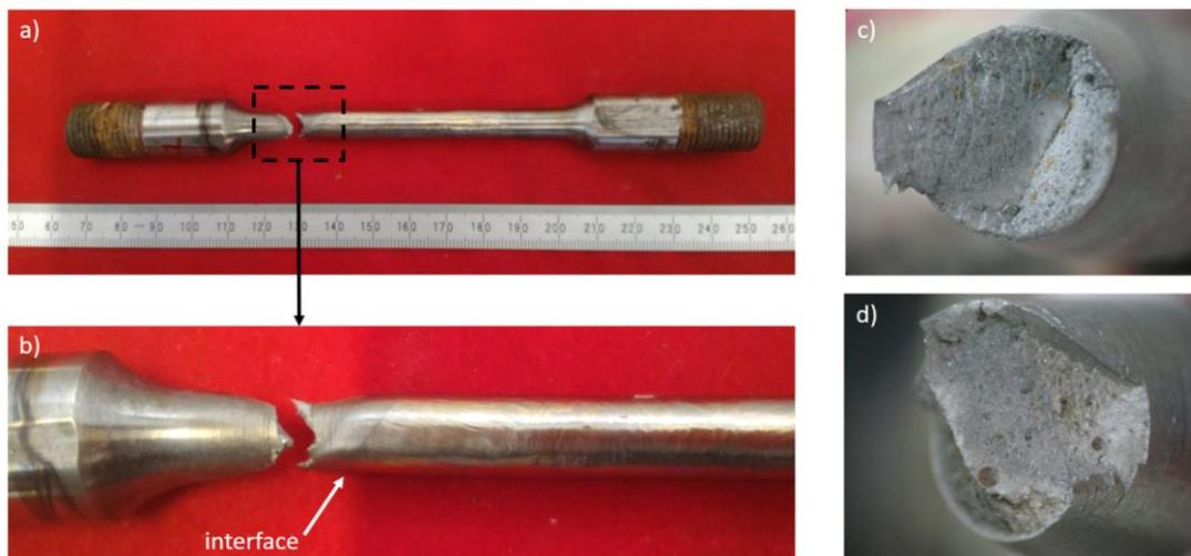
Figura 139 Análise pós-ensaio de BTB em corpo de prova extraído de junta tipo I, 10 horas de TTPS, ensaio 1 ao meio. a) Fotografia do CP após ensaio; b) Fotografia em maior aumento da região de fratura; c) e d) Imagens obtidas por estereoscopia da superfície de fratura.
