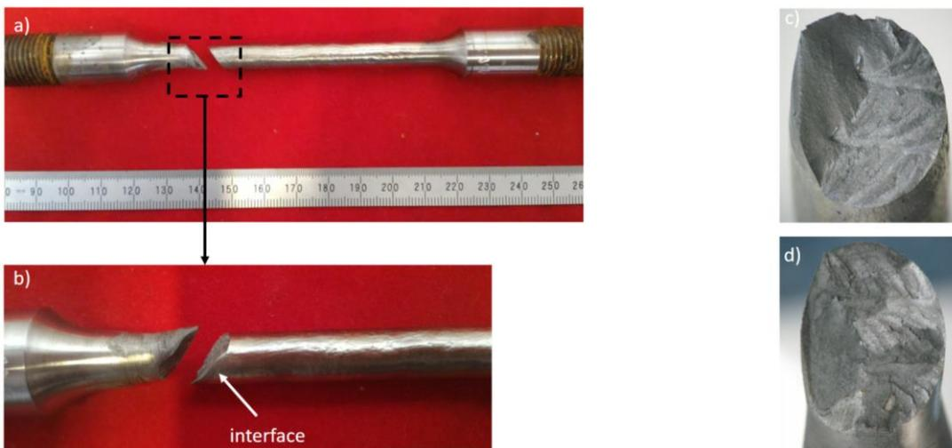
Figura 141 Análise pós-ensaio de BTDC em corpo de prova extraído de junta tipo I, 20 horas de TTPS, ensaio 1 ao meio. a) Fotografia do CP após ensaio; b) Fotografia em maior aumento da região de fratura; c) e d) Imagens obtidas por estereoscopia da superfície de fratura.
