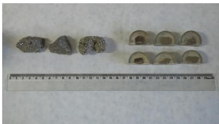
**Figura 3.3 – Amostra de pirita bruta e após a etapa de preparação.**
