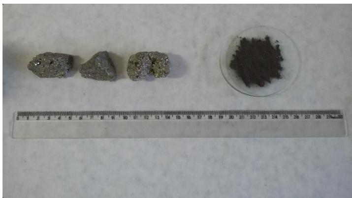
**Figura 3.2 – Amostra de pirita bruta e na forma de material particulado após a etapa de moagem.**
