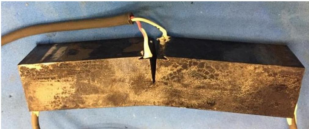
Figura 51 – Corpo de prova após ensaio em solução de projeto com a formação de um filme escuro superficial.
