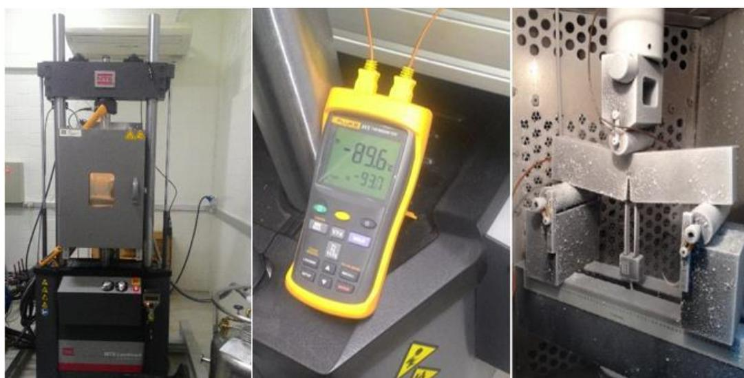
Figura 49 - Ensaio de CTOD à temperatura de  $-90^{\circ}\text{C}$ .
