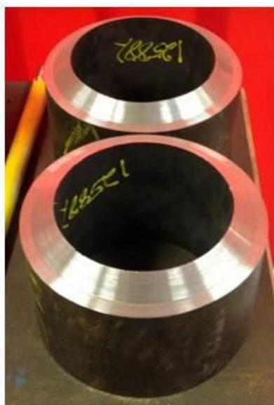
Figura 38 - Anéis de tubo de aço ASTM A333 Gr. 8 utilizados nas soldagens.
