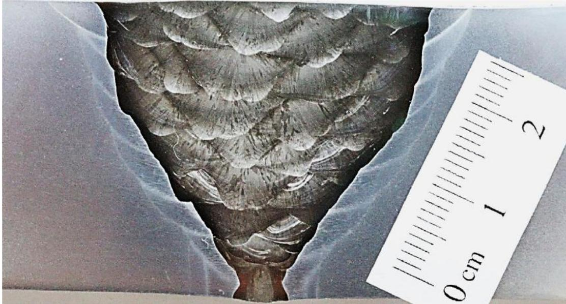
Figura 57 - Macrografia da junta soldada GTAW raiz e reforço + GMAW enchimento e acabamento.
