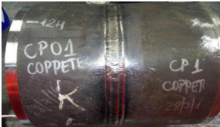
Figura 40 - Junta de aço 9Ni soldada com superliga de níquel 625.
