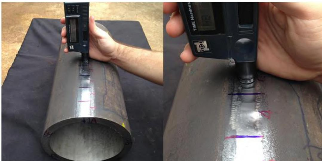
**Figura 26: Registro de medidas de dureza superficial.**
