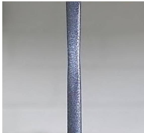
**Figura 54: Alongamento do revestimento isolado (A4) durante ensaio de tração.**
