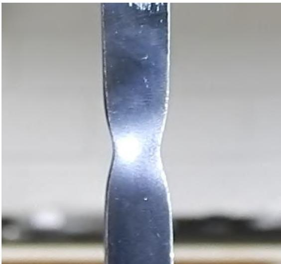
**Figura 53: Estricção do metal de base isolado (A3) durante ensaio de tração.**
