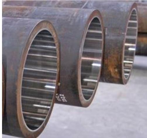
**Figura 5: Tubos cladeados mecanicamente por expansão (BUTTING, 2017).**
