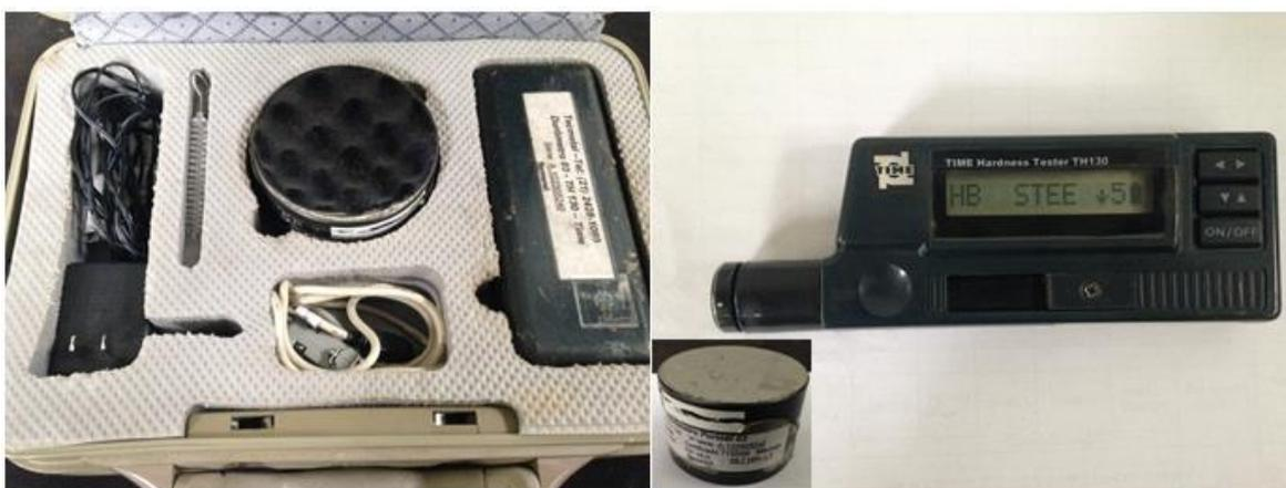
**Figura 24: Equipamento portátil durômetro Leeb.**
