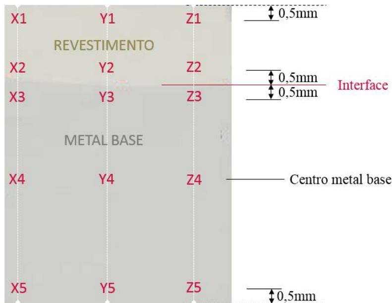
**Figura 65: Esquema representativo dos pontos de medida de dureza HV1 retirados após os ensaios de tração interrompidos, em amostras nas seções transversal e longitudinal.**
