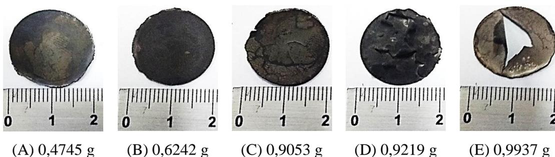
Foi verificado, após análise macroscópica dos depósitos, que os depósitos obtidos nas eletrólises com densidades de corrente a partir de  $200 \text{ A.m}^{-2}$  contém pontos de rachaduras e rompimentos, característicos da formação de bolhas de  $\text{H}_2$  que, adsorvidas na superfície do substrato, forçam a saída por meio da estrutura do depósito formado. Nos depósitos obtidos com densidades de  $100$  e  $150 \text{ A.m}^{-2}$ , observou-se uma estrutura macroscopicamente uniforme.
