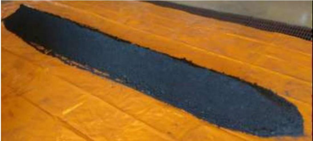
Figura 4.6 Mistura de minérios sobre lona em processo de homogeneização
