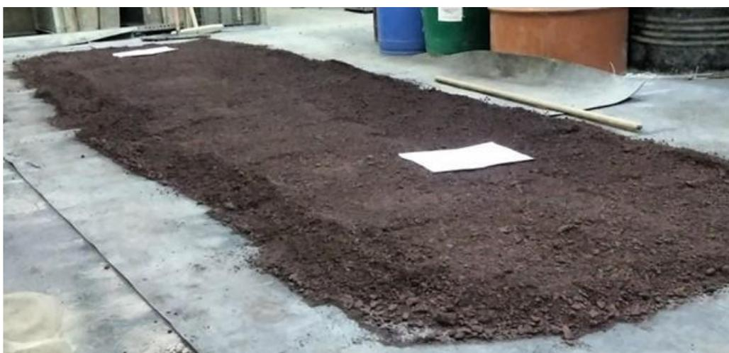
Figura 4.3 Amostra de minério espalhada para homogeneização nas instalações do LTM
