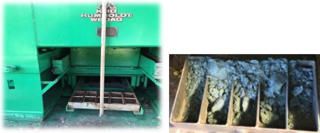
Figura 4.9 Dispositivo para coleta de amostra longitudinal ao rolo sendo introduzido entre os rolos (esquerda) e já contendo o material para análises (direita)
