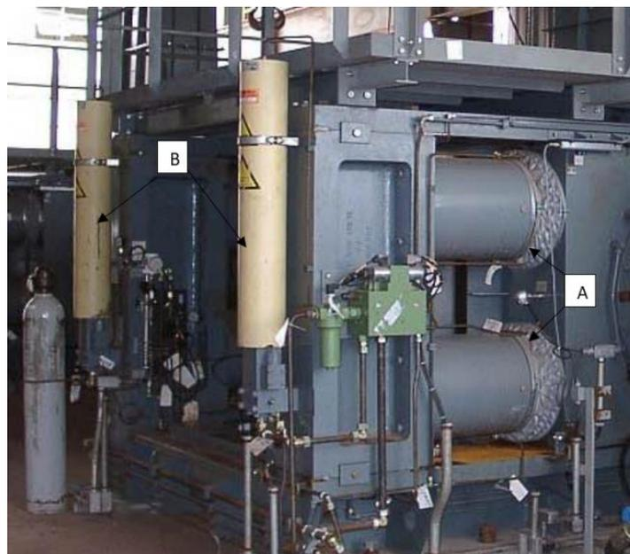
Figura 3.3. Sistema hidráulico da prensa de rolos: Cilindros hidráulicos (A), Acumuladores de Nitrogênio (B)
