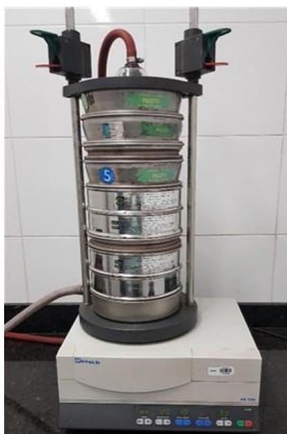
Figura 4.17 Peneirador Retsch utilizado nas medidas de distribuição granulométrica de partículas maiores que 500 µm.
