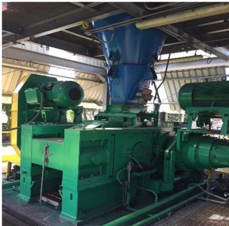
Figura 4.8 HPGR piloto utilizado para realização dos testes de prensagem
