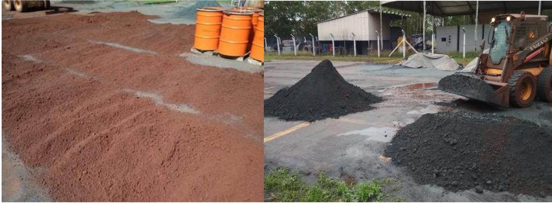
Figura 4.11 Homogeneização das misturas de minério e ajuste do teor de umidade
