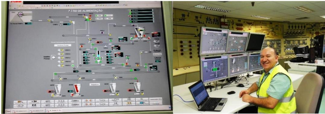
Figura 4.14 Tela do sistema supervisor utilizado para controle de processo e operador durante teste industrial de multiprensagem em HPGR industrial
