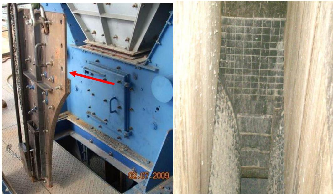
Figura 3.21 *Cheek plates* prontas para serem instaladas no HPGR (em destaque à esquerda) e já instaladas no equipamento (direita) (RODRIGUES, 2018)
