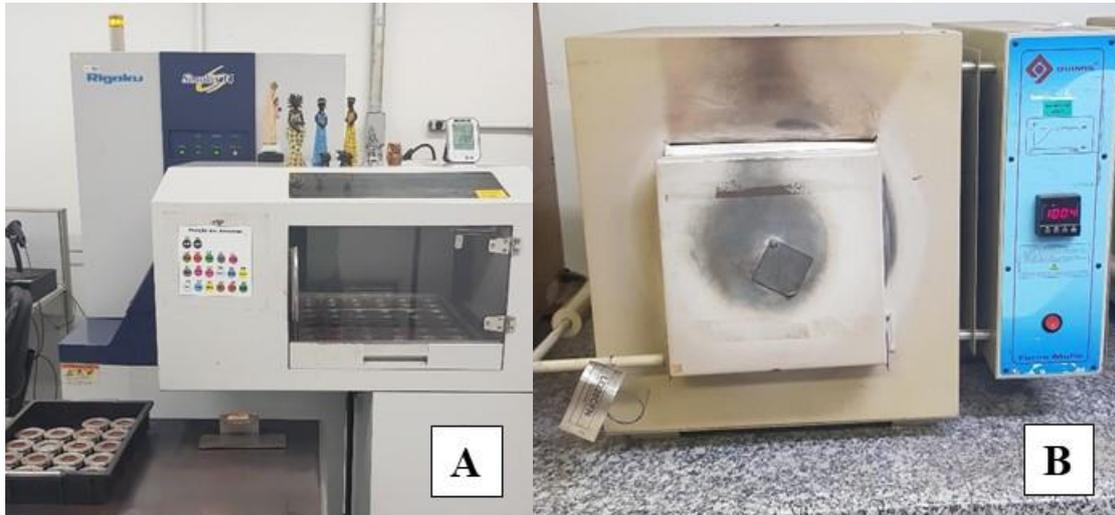
Figura 4.20 Espectrômetro de fluorescência de raio X (A) e mufla (B)
