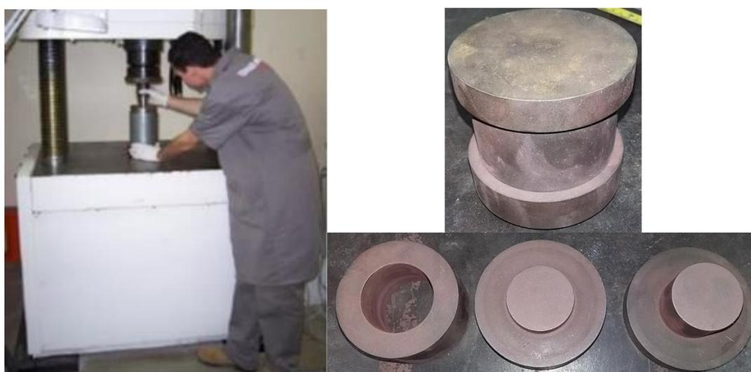
Figura 3.27 Prensa Shimadzu (esquerda) e acoplamento copo pistão utilizados nos testes de CLP (direita)
