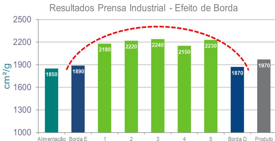
Figura 3.23 Efeito da posição de descarga da prensa na área superficial específica (Blaine), mostrando o efeito de borda em experimento industrial (BUENO e VIANNA, 2016)
