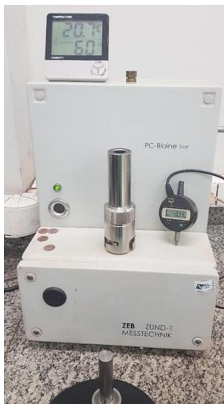
Figura 4.19 Analisador Blaine-Star para medição área superficial específica
