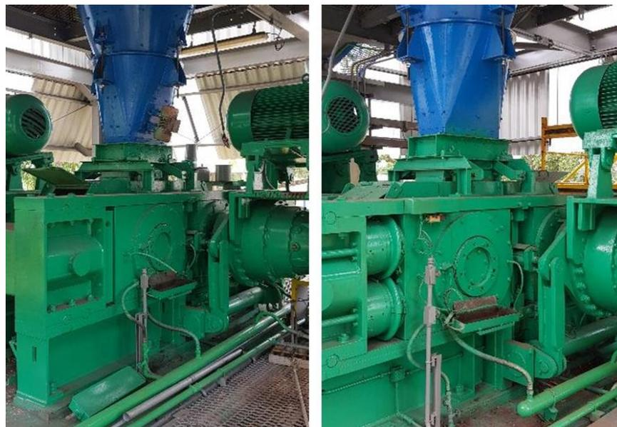
Figura 3.29 Prensa em escala piloto KHD/WEIR
