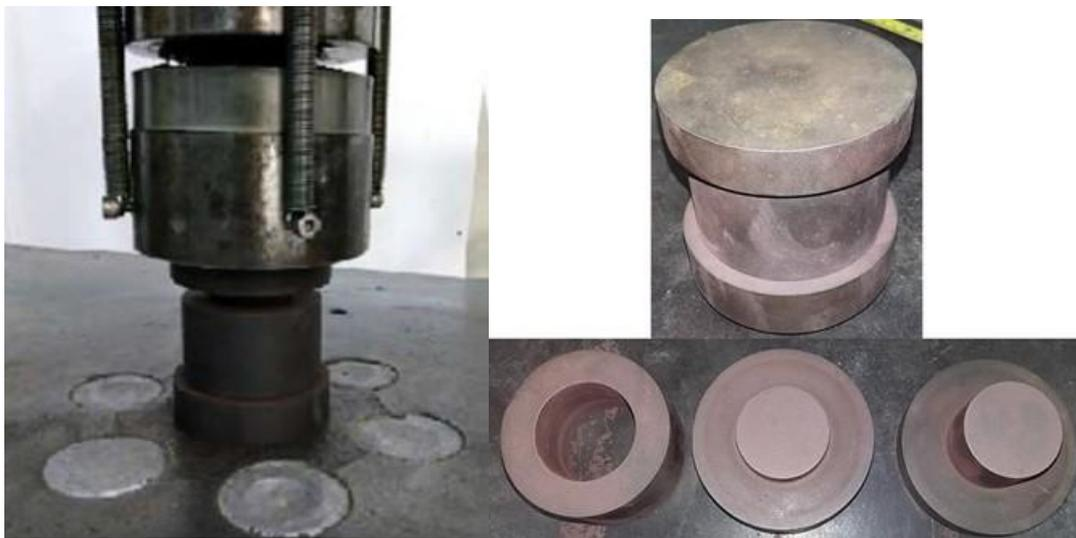
Figura 4.4 Prensa Shimadzu com copo pistão acoplado utilizados nos testes de CLP
