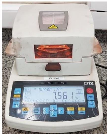
Figura 4.12 Balança medidora de teor de umidade
