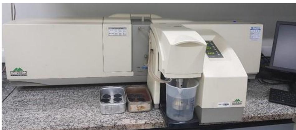
Figura 4.18 Analisador de partículas a laser Malvern Mastersizer® 2000 utilizado para medida da distribuição granulométrica de partículas menores que 500  $\mu\text{m}$ .
