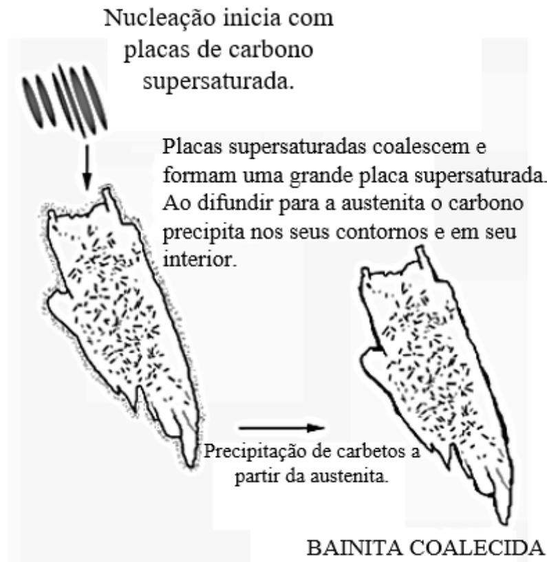
Figura 13 - Representação esquemática da formação da bainita coalescida. Adaptado de [30].
